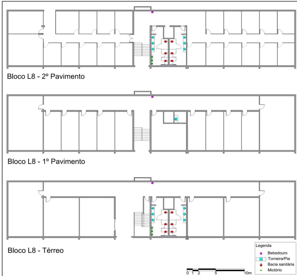
Os banheiros do Bloco L8 são equipados com torneiras economizadoras de acionamento hidromecânico, tal como ocorre nos mictórios, e com bacias sanitárias descarga do tipo válvula direta, sem caixa, tendo uma torneira comum em cada banheiro utilizada pelos funcionários de limpeza. Na cozinha é utilizada uma torneira de acionamento comum e nas áreas de circulação encontram-se instalados três bebedouros. A quantidade total de aparelhos sanitários instalados no Bloco L8 está apresentada na tabela 6.
