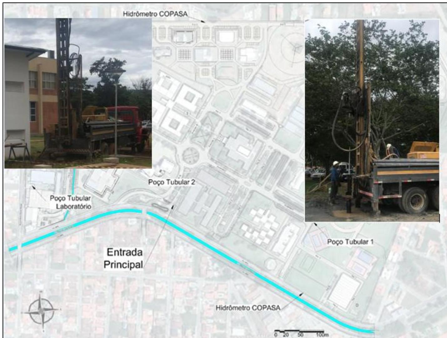
O teste de bombeamento apresentou uma vazão total de 14 m<sup>3</sup>/h, sendo 12 m<sup>3</sup>/h no poço 1 e 2 m<sup>3</sup>/h no poço 2, equivalente a 10.080 m<sup>3</sup>/mês, significativamente superior ao maior consumo de água registrado na UNIFEI, de 4.237 m<sup>3</sup>/mês, conforme
