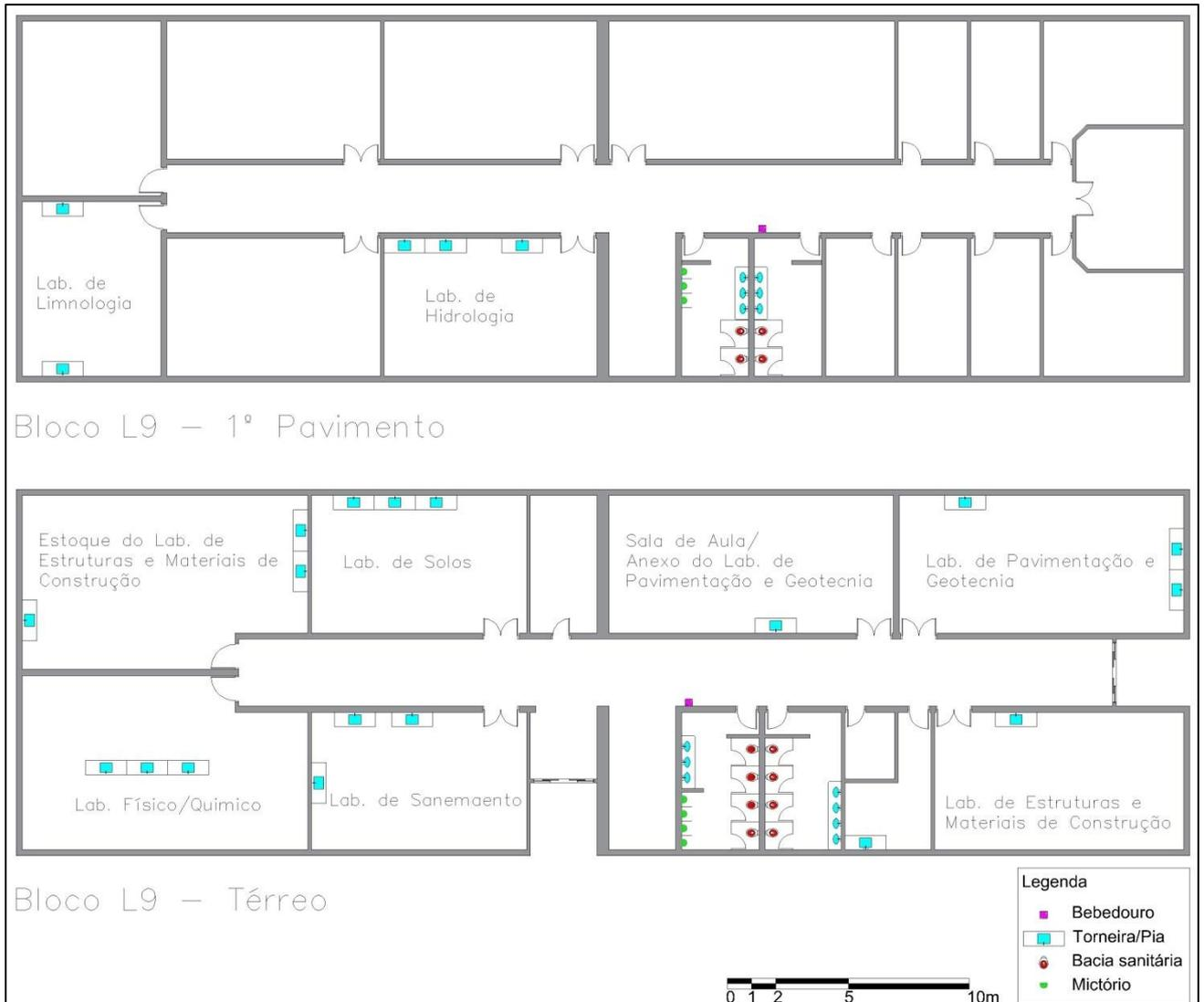
Os banheiros do Bloco L9 são equipados com torneiras economizadoras de acionamento hidromecânico para as pias e os mictórios enquanto as bacias sanitárias utilizam válvulas diretas. Há uma torneira comum em cada banheiro utilizada pelos funcionários de limpeza. Na cozinha a torneira existente é de acionamento comum e nas áreas de circulação existem dois bebedouros. A quantidade total de aparelhos sanitários instalados no Bloco L9 estão apresentados na tabela 7.
