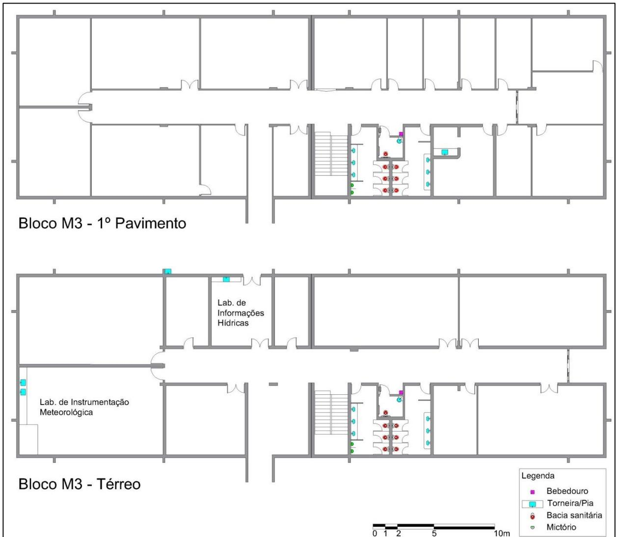
Os banheiros deste Bloco são dotados com torneiras economizadoras de acionamento hidromecânico, tal como ocorre nos mictórios, e as bacias sanitárias utilizam caixa acoplada de duplo acionamento para 3 ou 6 L. Há uma torneira comum sob cada uma das pias dos banheiros, utilizadas pelos funcionários de limpeza. Para as áreas de laboratório e cozinha as torneiras são comuns, além de existirem dois bebedouros nas áreas de circulação.
