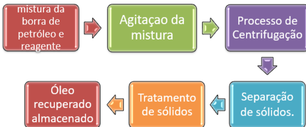
Figura 2.4. Esquema do processo de centrifugação.
