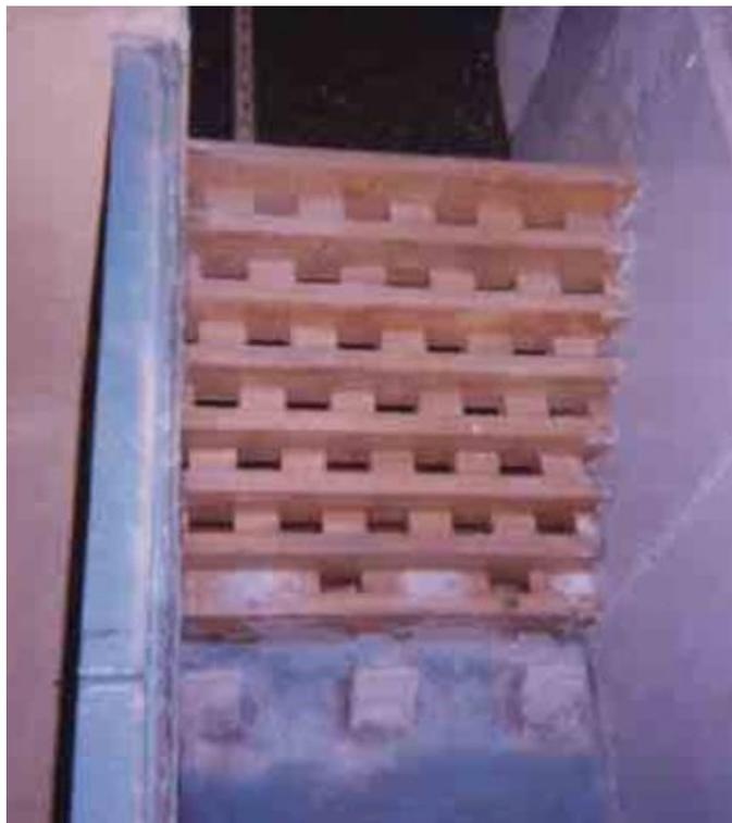
**Figura 1 – Vista Superior do Modelo Reduzido da Soleira de Admitância**
