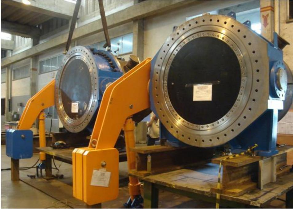
**Figura 23** – Válvula tipo Borboleta para Centrais
