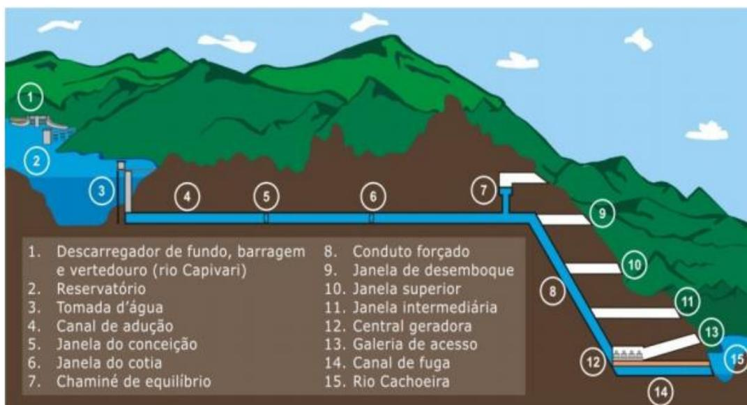
**Figura 3** - Seção esquemática da UHE Capivari/Cachoeira
