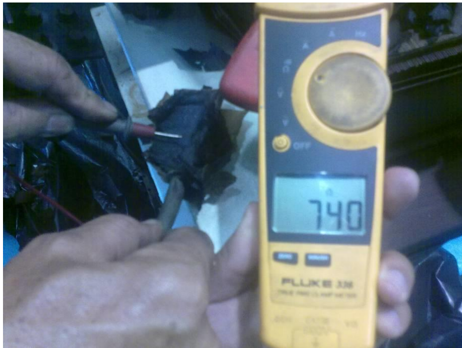
Figura 5.7 – Resultado de avaliação da presença de enxofre corrosivo em óleo isolante Fonte: Autor
