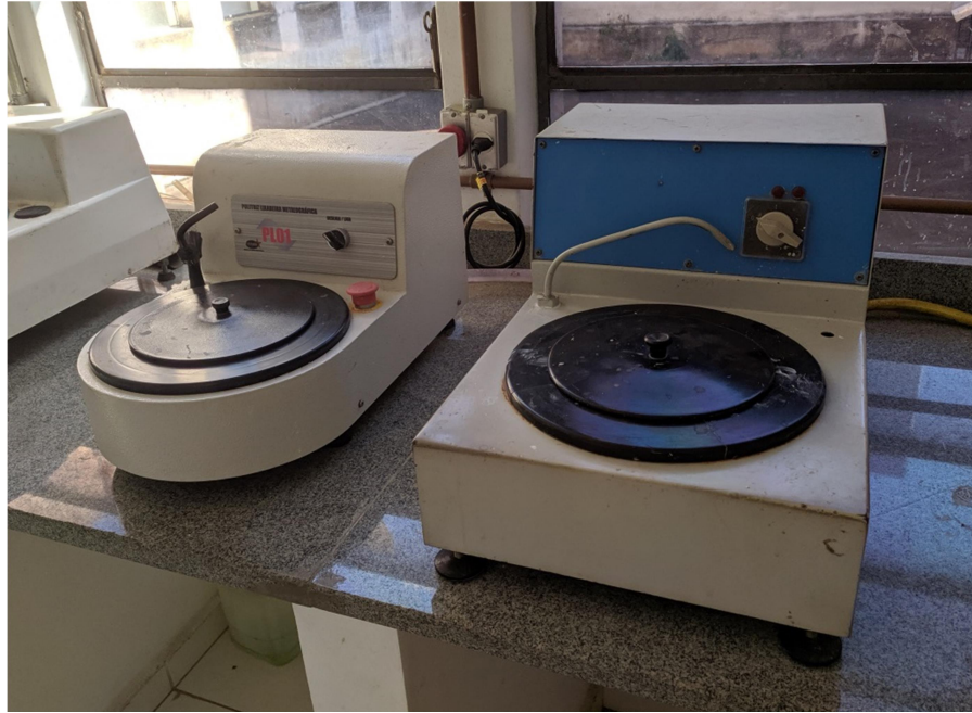
Figura 4.14 Politrizes utilizadas no preparo das amostras
