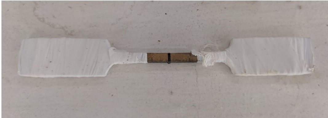
Figura 4.11 Corpo de prova protegido com Teflon
