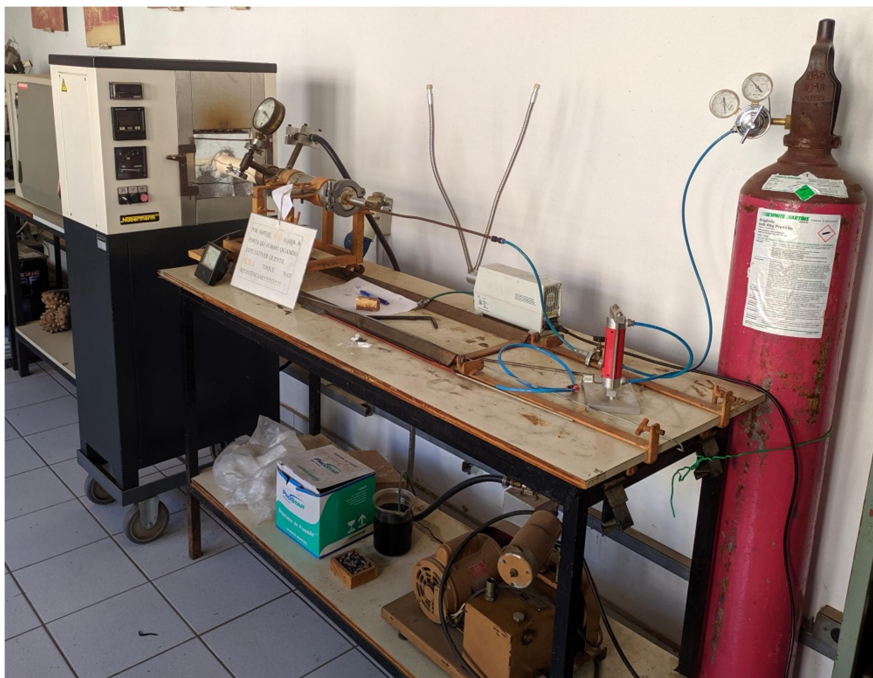
Figura 4.6 Forno Nabertherm com atmosfera controlada utilizado nos tratamentos de envelhecimento
