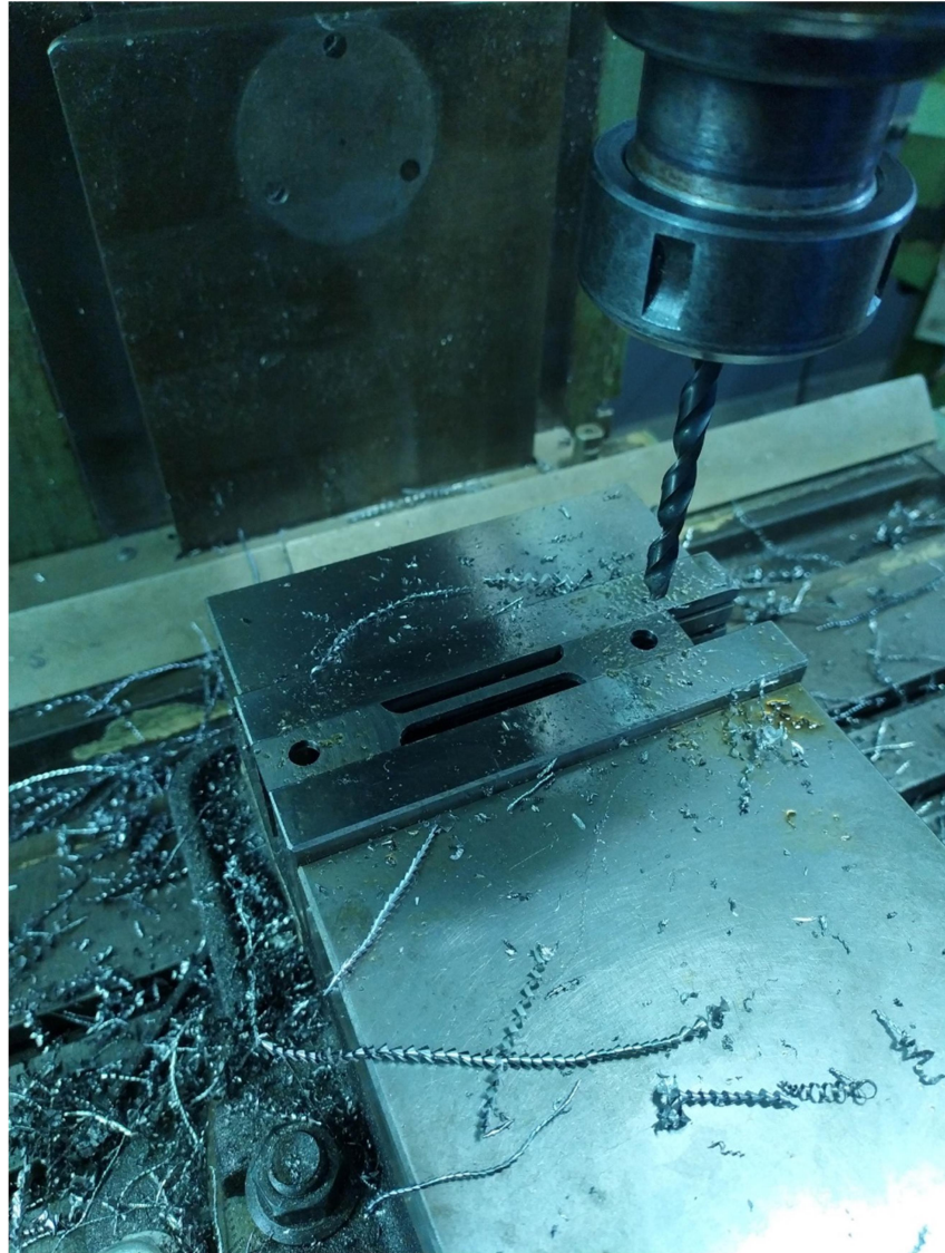
Figura 4.3 Operação de Furação
