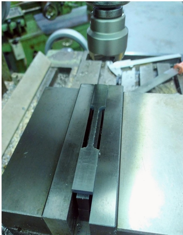
Figura 4.2 Fresamento dos corpos de prova
