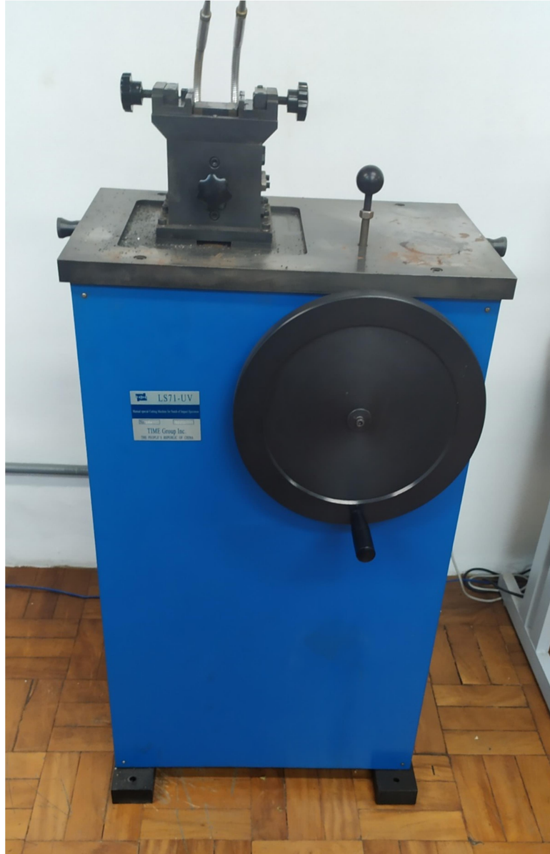
Figura 4.4 Brochadeira utilizada para operação de entalhe
