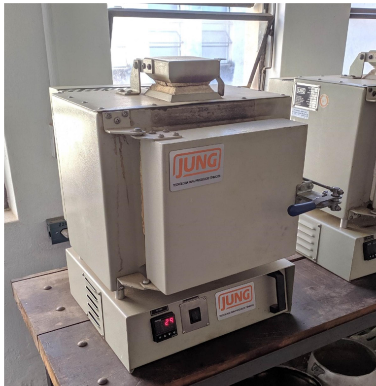
Figura 4.5 Forno Jung utilizado no tratamento de solubilização
