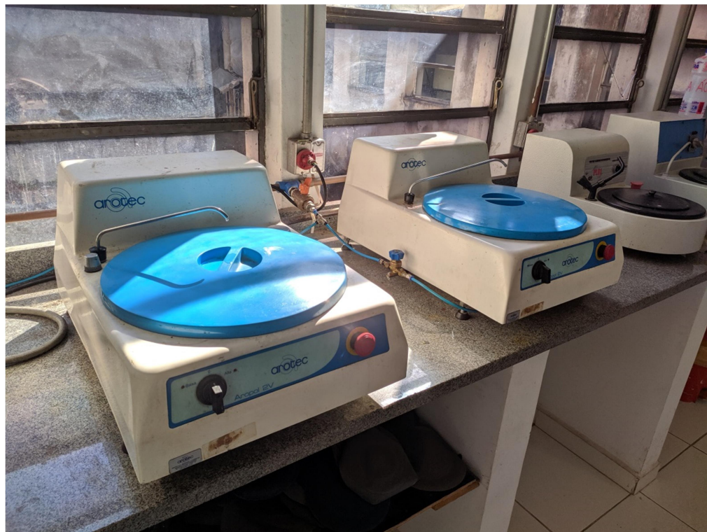
Figura 4.13 Lixadeiras utilizadas no preparo das amostras
