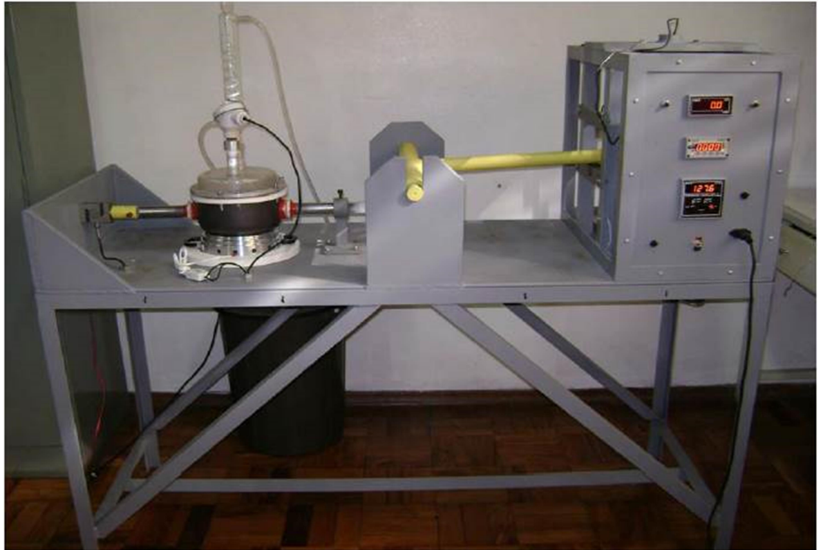
Figura 4.10 Equipamento de ensaio de CST com carga constante
