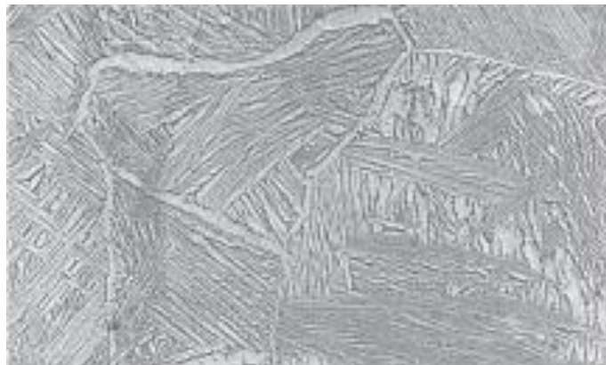
Figura 4 - Micrografia mostrando a fase \alpha (clara) nucleada ao longo e a partir de contorno de grão. Ampliação 500x Fonte: BANERJEE (2007).
