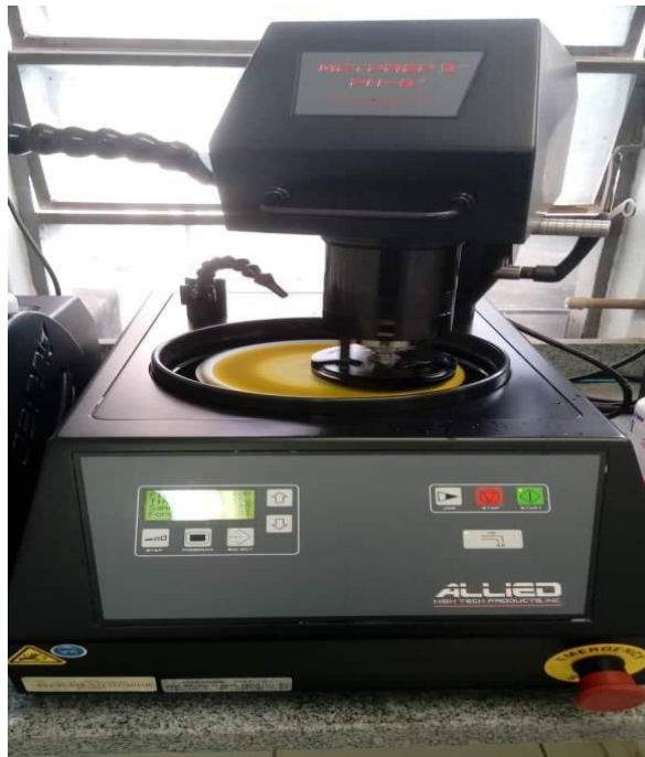
Figura 26 - Equipamento utilizado para polimento - Metprep3 Fonte: Autor.
