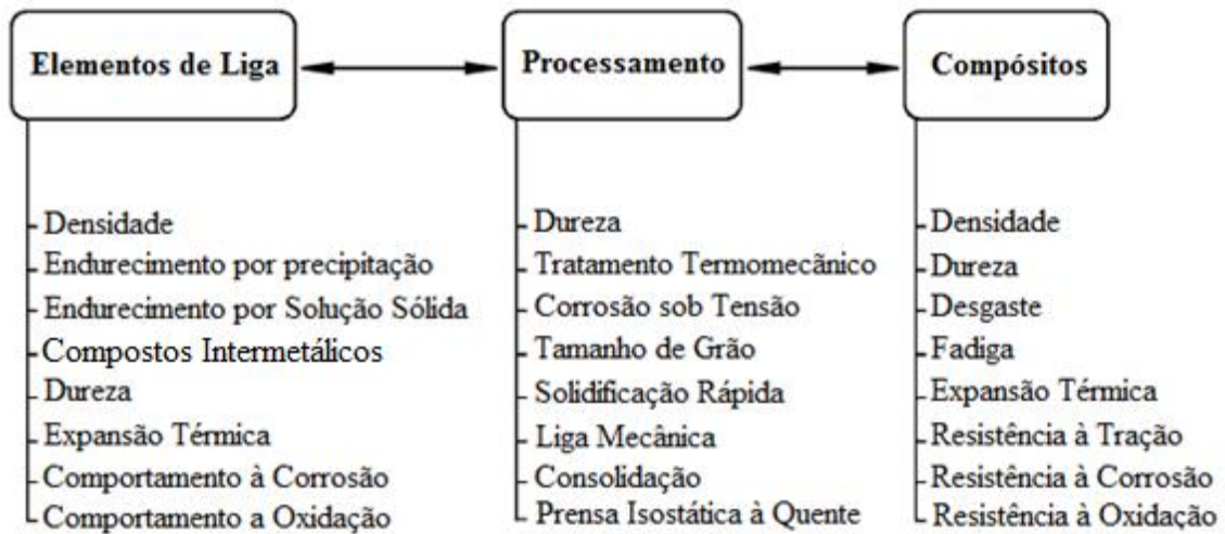
Figura 12 - Maneiras de melhorar as propriedades mecânicas das ligas de titânio Fonte: LEYENS E PETERS, 2003.
