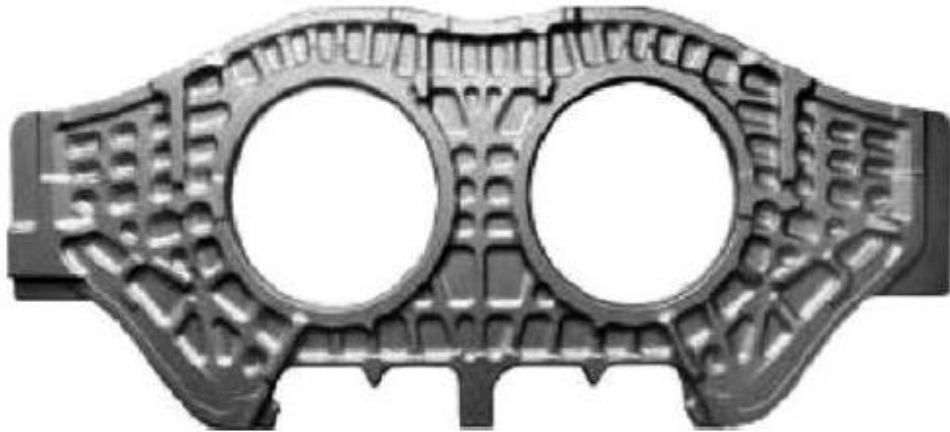
Figura 14 - Bulkhead F-22, forjado, liga Ti-64 de aproximadamente 3000 kg, 1,7 m de altura e 4 m de largura Fonte: BOYER, 2010
