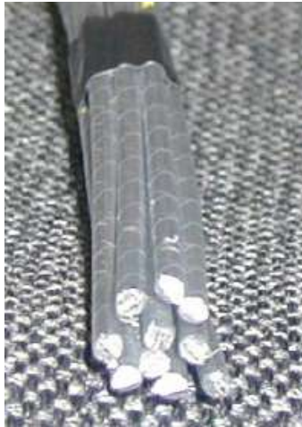
Figura 5.8 – Exemplo de fio de alumínio isolado com Nomex®
