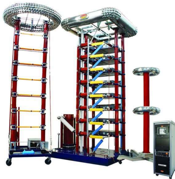
Figura 2.21 – Gerador de impulsos atmosféricos
