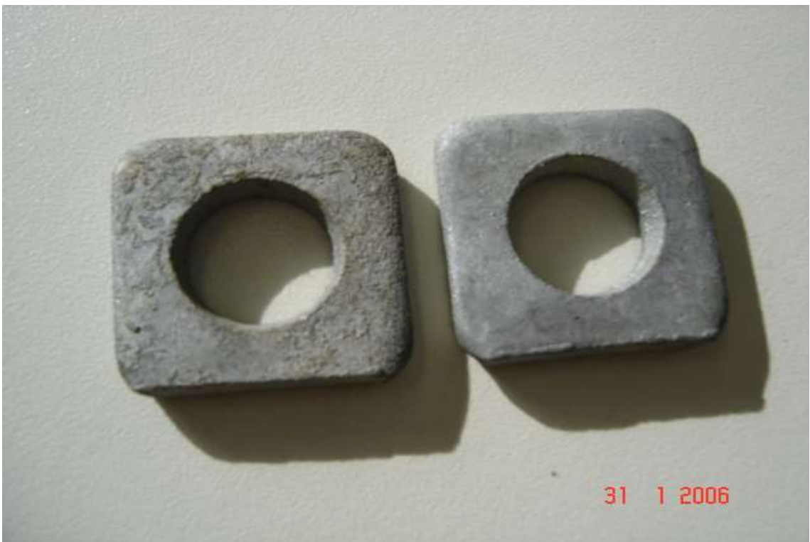
Figura 75: Na esquerda, arruela galvanizada a fogo após uma semana de imersão profunda no lago usina
