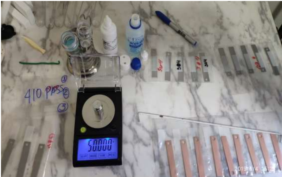
Figura 34: Cupons dos diversos metais e pesagem inicial com balança de milésimo de grama.
