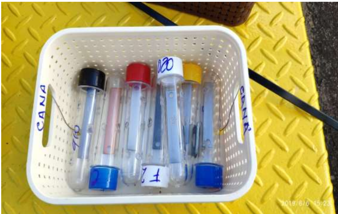
Figura 35: Cesto com cupons inicialmente utilizado Fonte: acervo do autor (2019)
