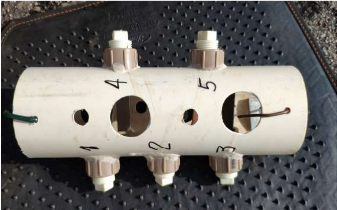
Figura 37: Dispositivo criado para fixar cupons Fonte: acervo do autor (2019)
