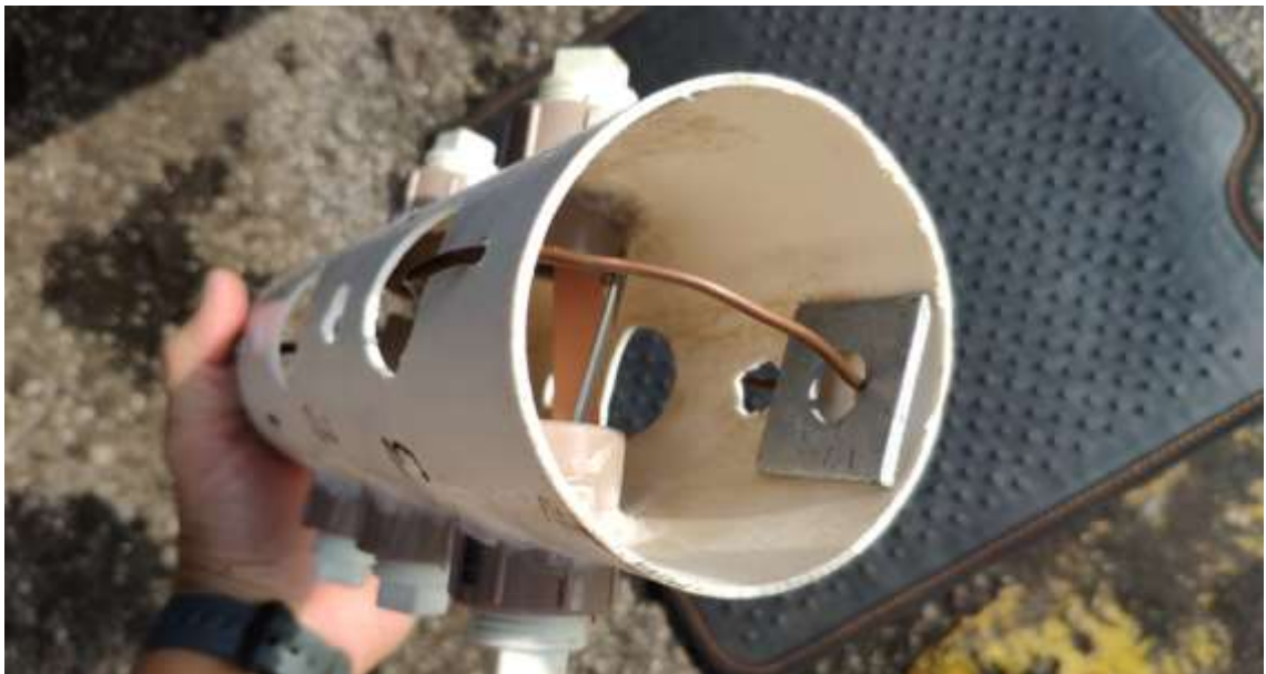
Figura 38: Vista interna com cupons e arruela de teste. Fonte: acervo do autor (2019)
