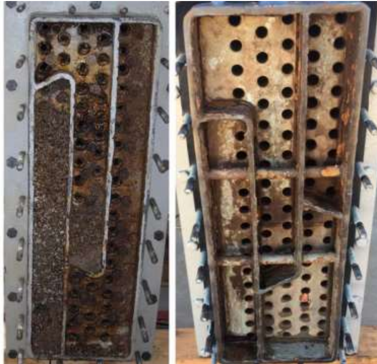
Figura 27: Trocador de calor - da esquerda com biofilme e da direita alimentada por HODUV . Fonte: Pucherelli et al. (2018)
