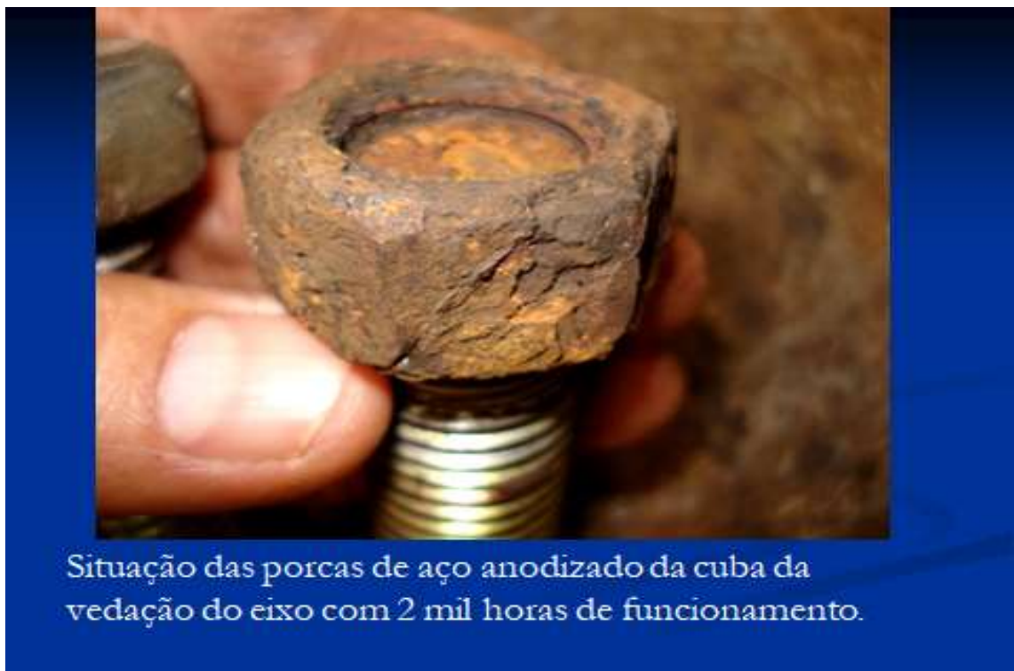
Figura 54: Corrosão na porca de fixação da vedação do eixo.
