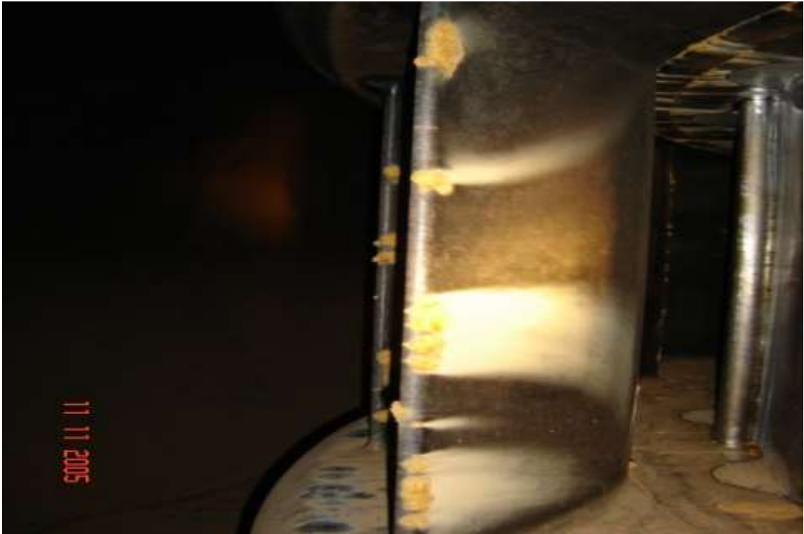
Figura 67: Tubérculos no vértice de palheta do pré-distribuidor com 360 h de operação.
