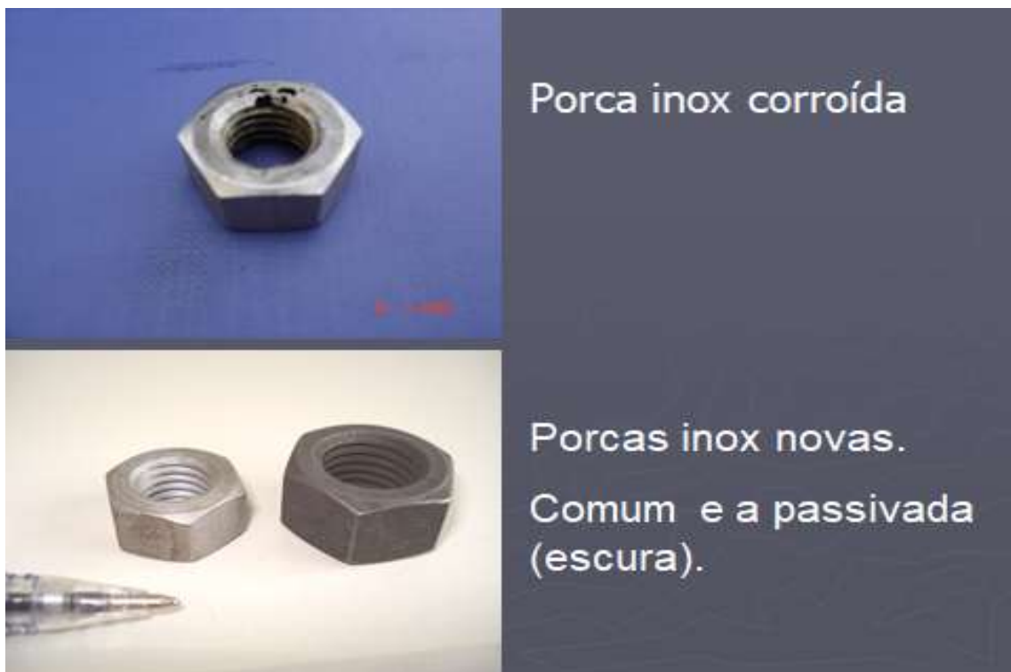
Figura 62: Ataque corrosivo em porca inox AISI 304 e diferença entre porca passivada.
