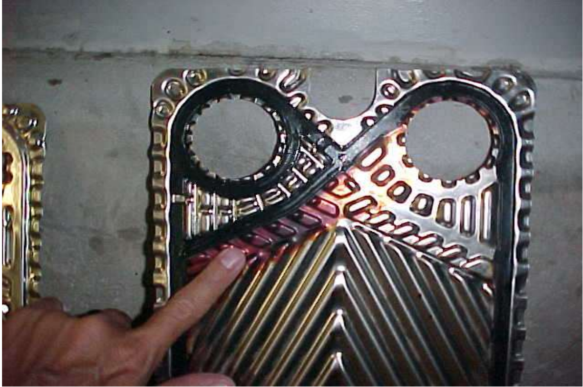
Figura 20: Placa de trocador de calor após limpeza. Fonte: acervo do autor (2003)
