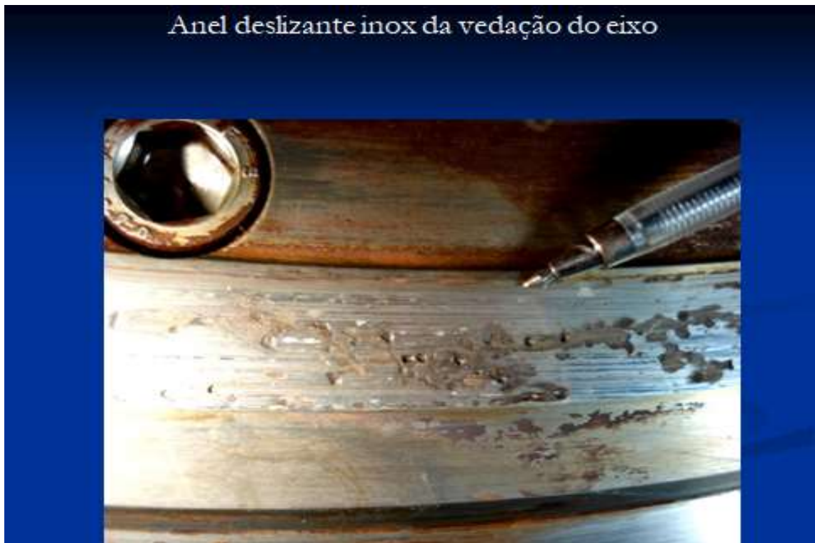
Figura 53: Corrosão na face de vedação de contato com cinta de grafite.
