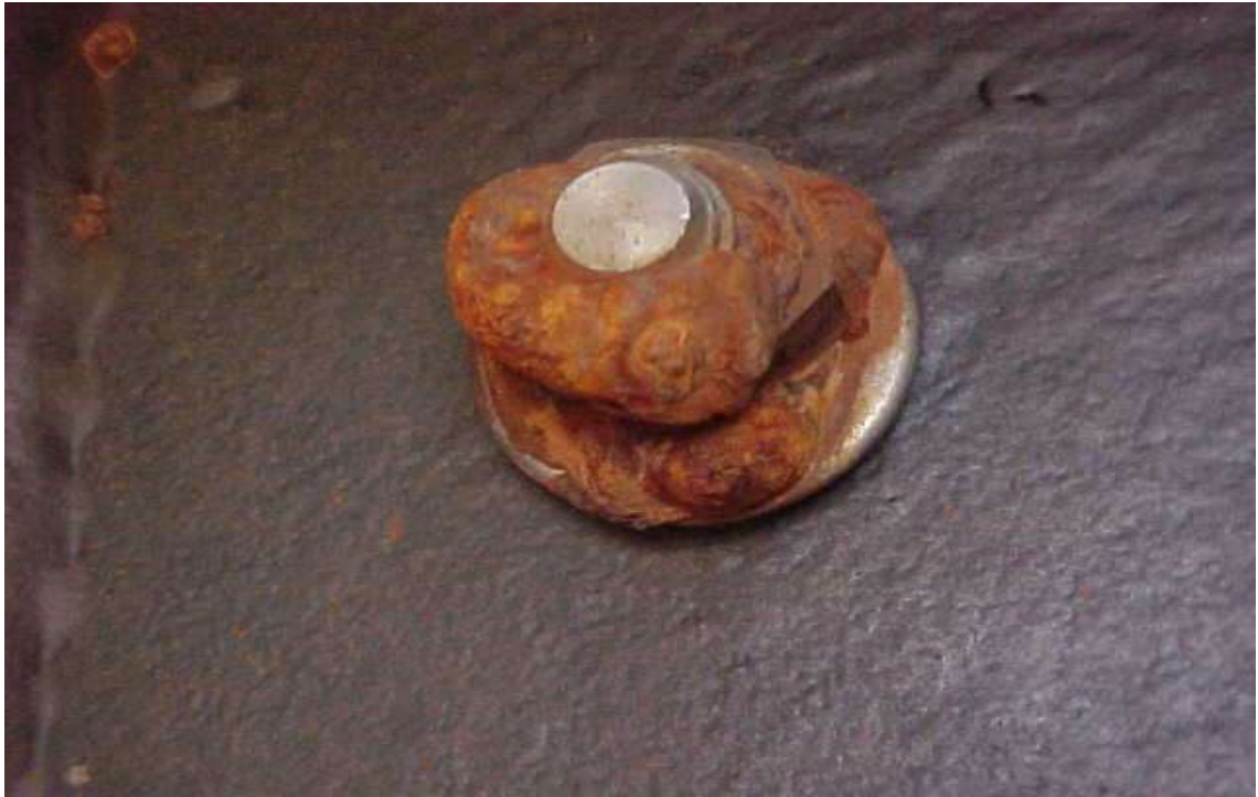
Figura 13: Porca aço inoxidável AISI 304 atacada por BRS e coberta pelo tubérculo. Fonte: acervo do autor (2005)
