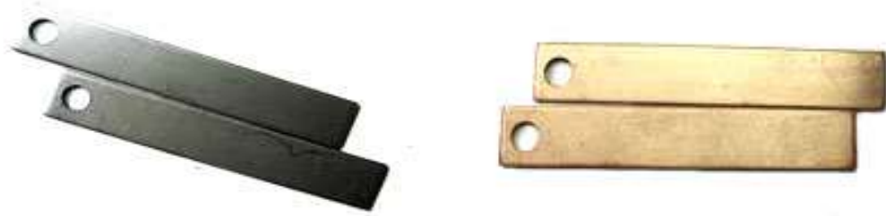
Figura 19: Cupons para teste de corrosão Fonte: Usinagem Franchi Ltda (2019)
