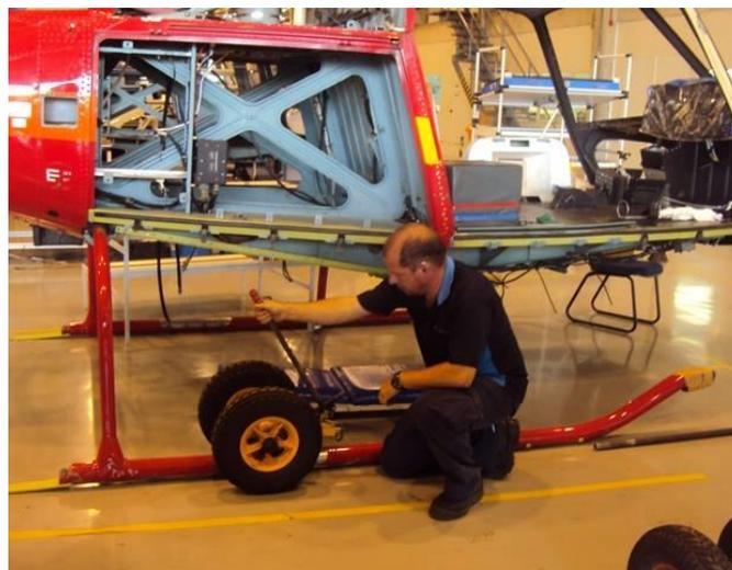
Figura 5.4: Roda de reboque no esqui do helicóptero
