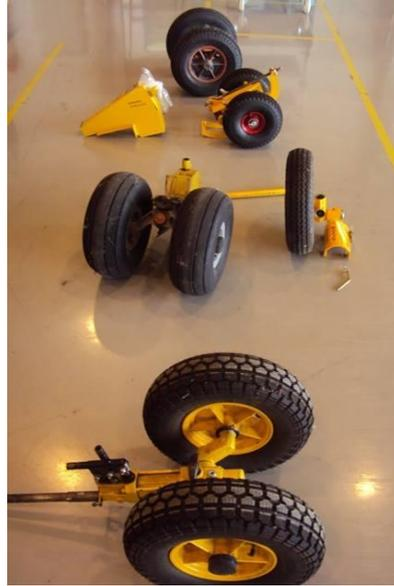
Figura 5.3: Diferentes tipos de roda de reboque
