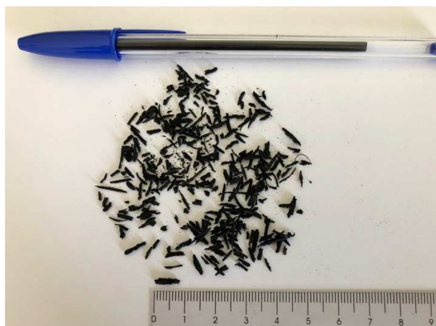
Figura 13: Resíduo de borracha empregado na produção do CAA.
