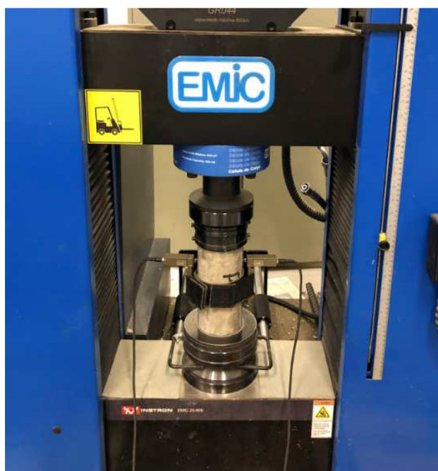
Figura 17: Execução do ensaio de módulo de elasticidade estático.
