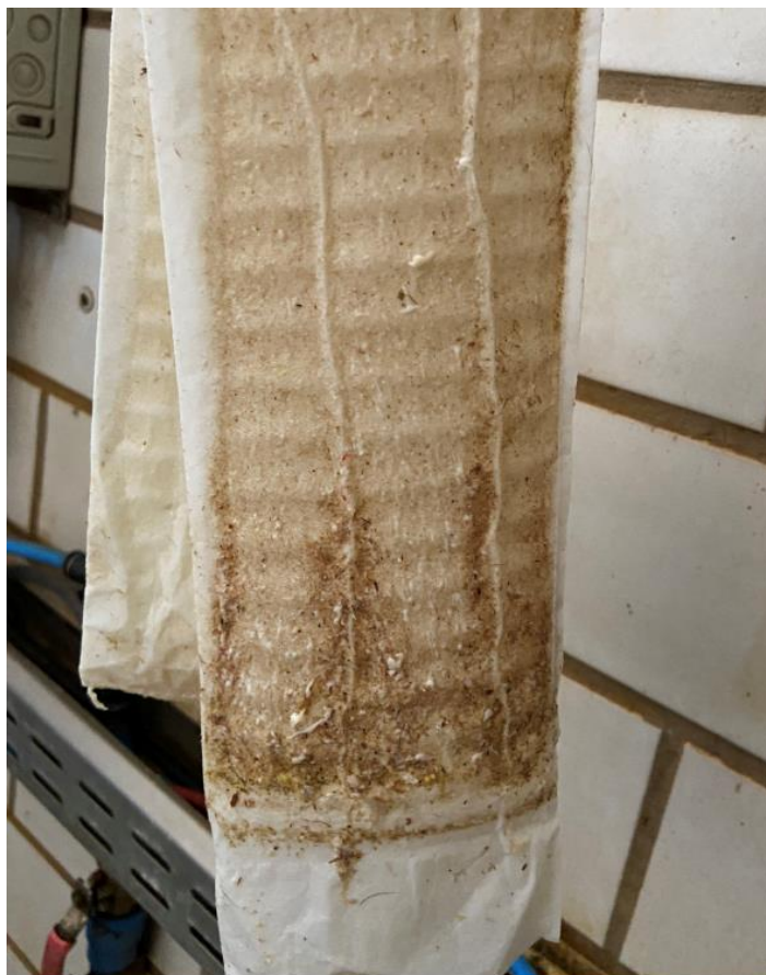
Figura 6.28 – Sujidade do filtro de leite ao final do turno de ordenha
