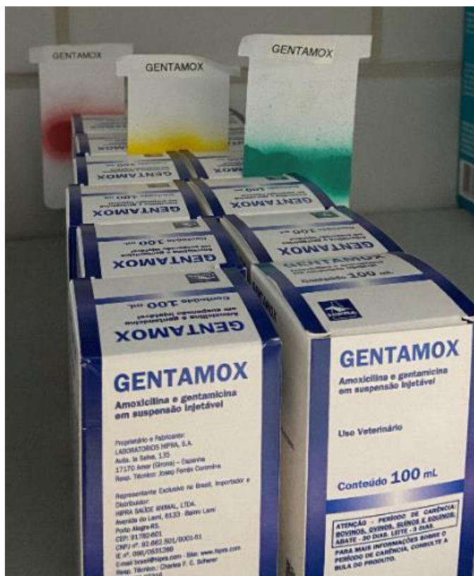
Figura 6.22 – Cartões kanban colocados nos pontos de reposição dos medicamentos
