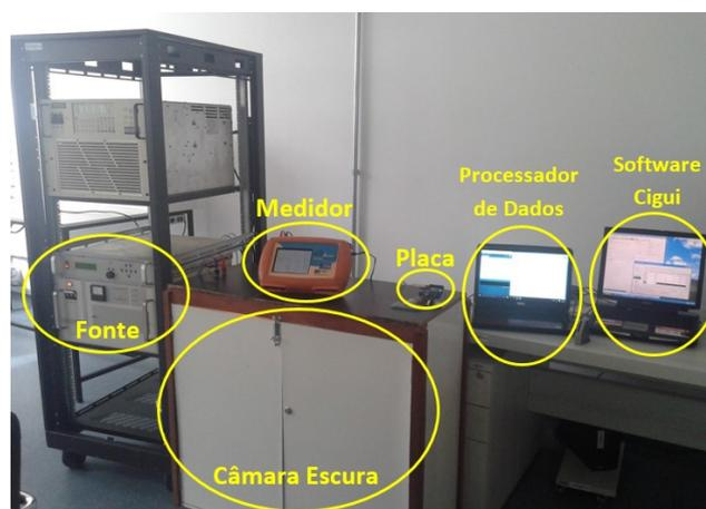
Figura 20 – Ligação Real dos Equipamentos Utilizados no Experimento
