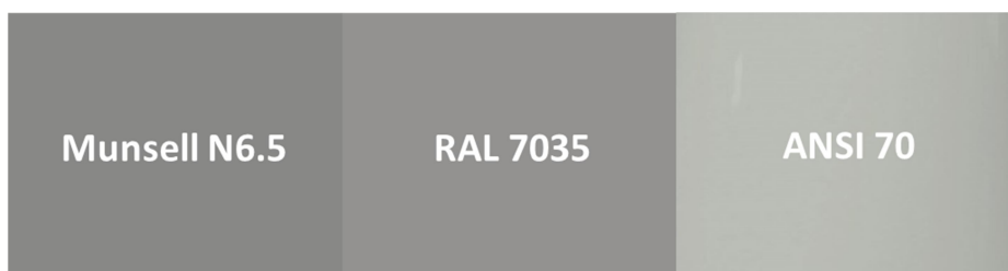
Figura 55 - Diferença de tonalidade entre as cores mais usuais para capacitores
