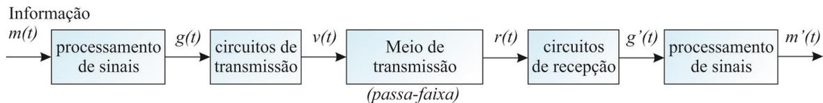
**Fig. 55:** Diagrama de blocos genérico de sistemas de comunicação.
