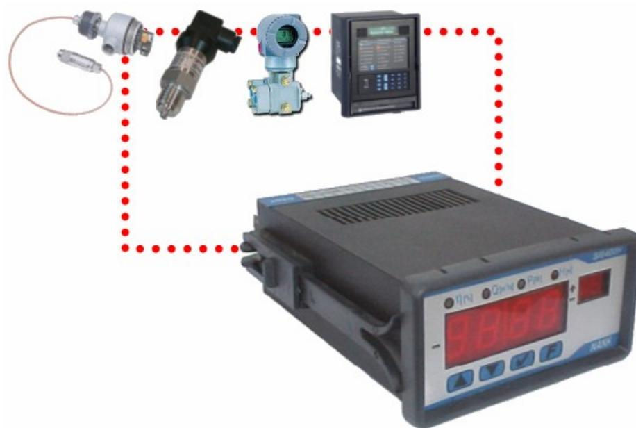
Figura 3 – Equipamento desenvolvido e diagrama esquemático de conexão de sensores.
