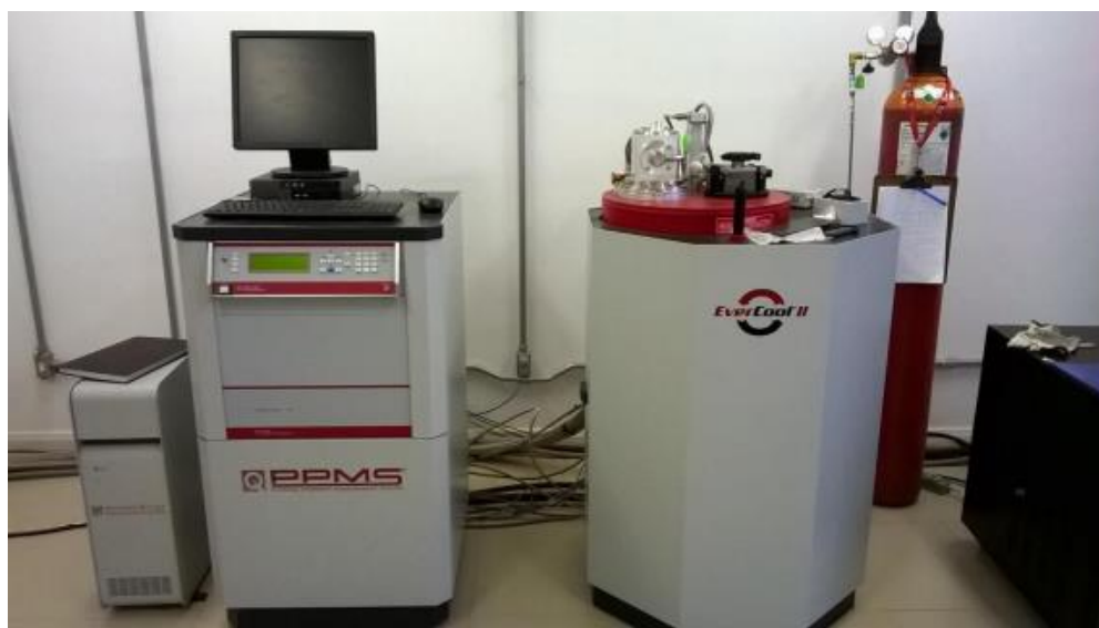
Figura 3.2 - Imagem do PPMS modelo EverCool II do Laboratório de Magnetotransporte em Baixas Temperaturas usado para medições de magnetorresistência.
