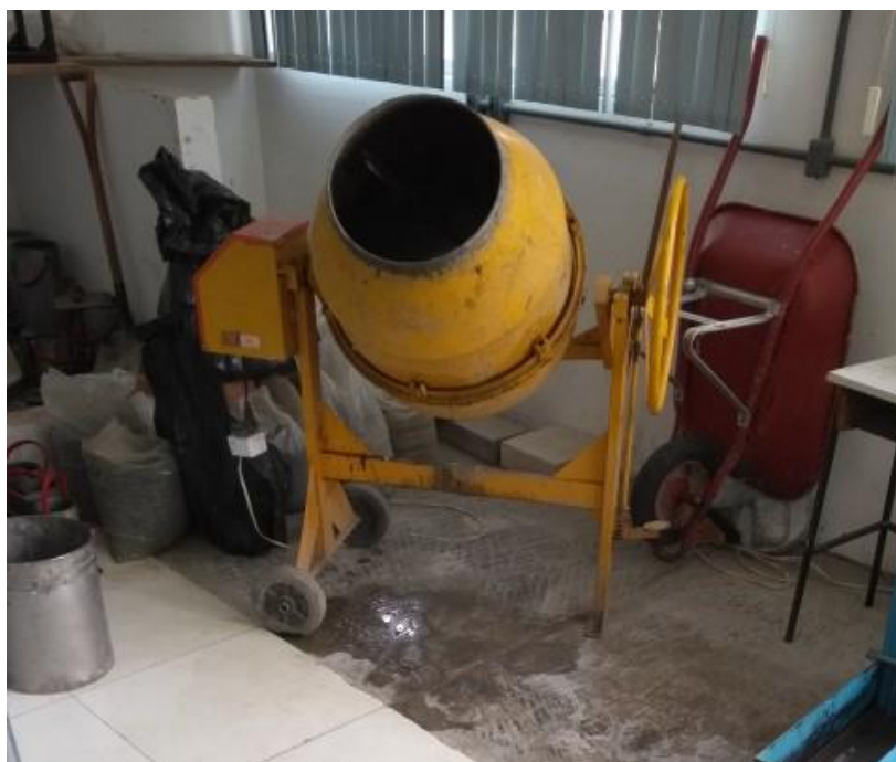
Figura 16: Betoneira utilizada para mistura dos materiais (Fonte: PRÓPRIO AUTOR, 2020).
