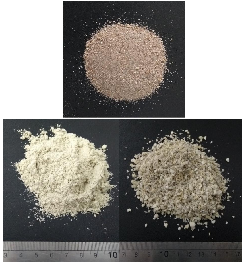
Figura 23: Agregados utilizados (a) areia natural e Resíduo de poliuretano (RPU) oriundo da reciclagem de refrigeradores separados segundo granulometria (a) e miúda G1) e (b) graúda (G2) (Fonte: PRÓPRIO AUTOR, 2021).
