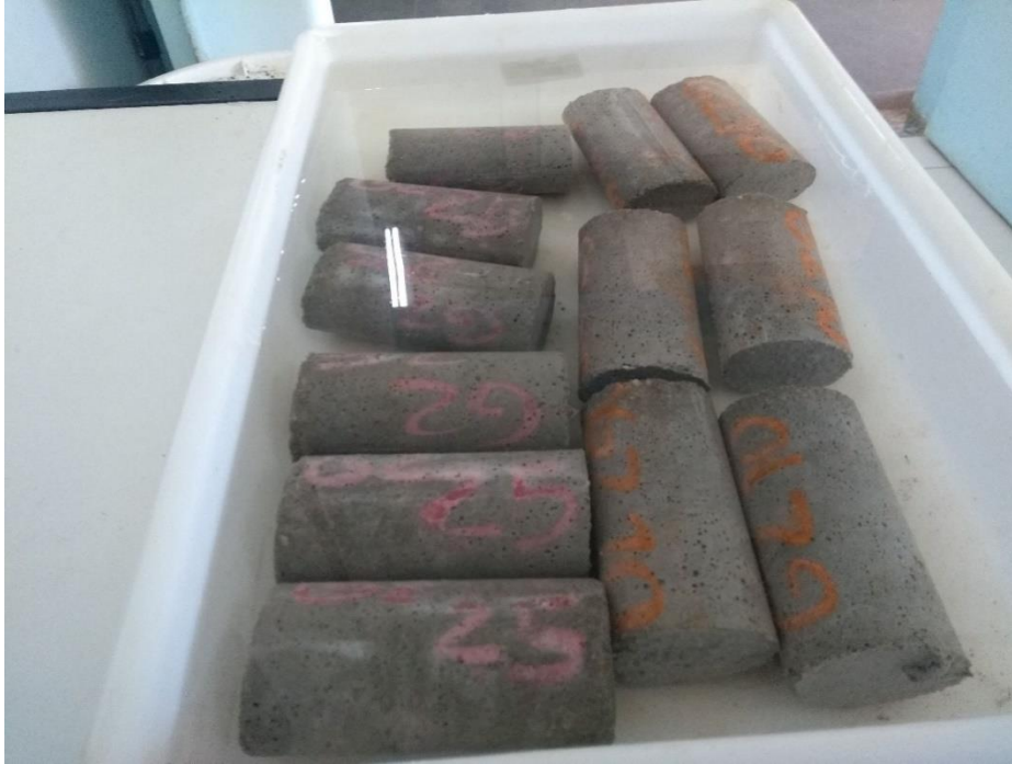
Figura 18: Corpos de prova depois de desmoldados (Fonte: PRÓPRIO AUTOR, 2020).
