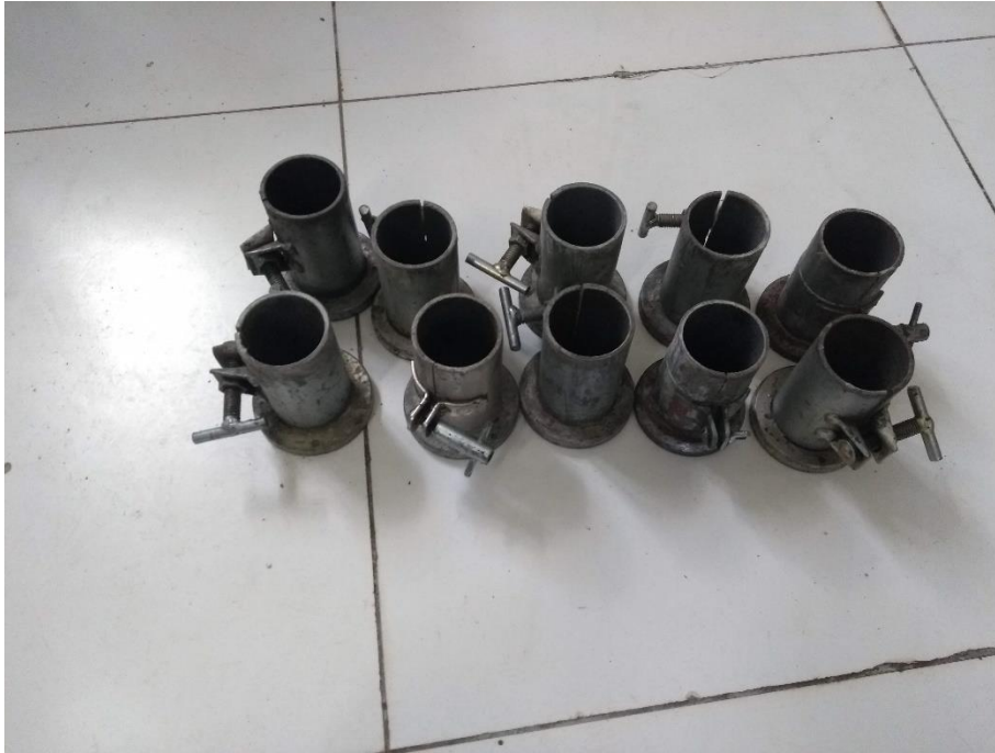
Figura 17: Moldes para corpo de prova cilíndrico (Fonte: PRÓPRIO AUTOR, 2020).
