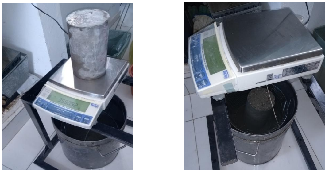
Figura 19: Ensaio de massa específica em corpo de prova de concreto (Fonte: ADAPTADA ROGUE, 2020).
