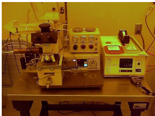
Figura 2.29. Fotoalinhadora Karl Suss MJB-3 Mask Aligner do CCS/Unicamp.
