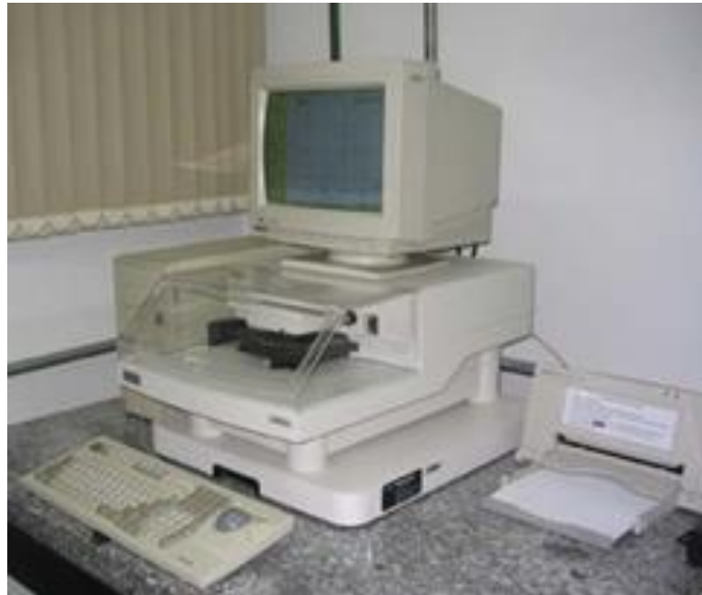
Figura 2.16. Perfilômetro modelo Alpha-Step 500, usado para determinar a espessura dos filmes AlN, do Laboratório Associado de Sensores e Materiais (LAS) no INPE.
