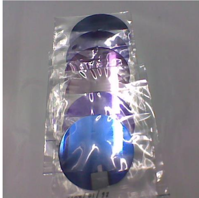
Figura 2.3. Fotografia dos filmes finos depositados sobre substrato de Si(100) tipo-p por pulverização reativa com magnetron e fonte de RF. Deposições realizadas no Laboratório de Plasmas e Processos (LPP/ITA/DCTA).
