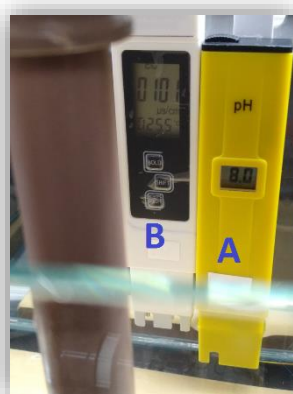
Fig. 19 - Medidores com os sensores mergulhados na solução e instalados na lateral interna do reservatório. A-medidor de pH, B-medidor de condutividade. Fonte: Autor.
