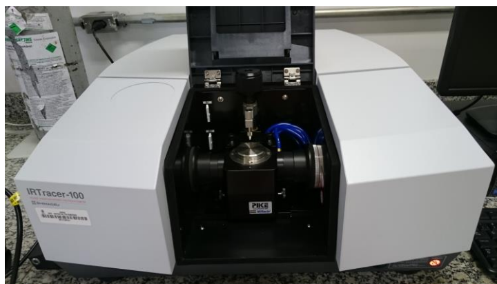
Figura 4.14. Espectrofotômetro utilizado na análise na região do infravermelho.
