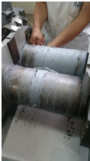
Figura 4.8. Prensa de rolo utilizada para a homogeneização do SiR/PVH. Fonte: INCT.
