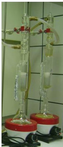
Figura 4.11 – Equipamento de Soxhlet para a determinação do teor de gel. Fonte: IPEN-USP.
