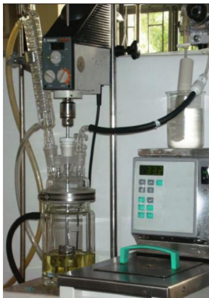
Figura 4.1. Reator semi-industrial utilizado para a reação de epoxidação do óleo de soja. Fonte: LAT-EFEI (FAPEMIG).
