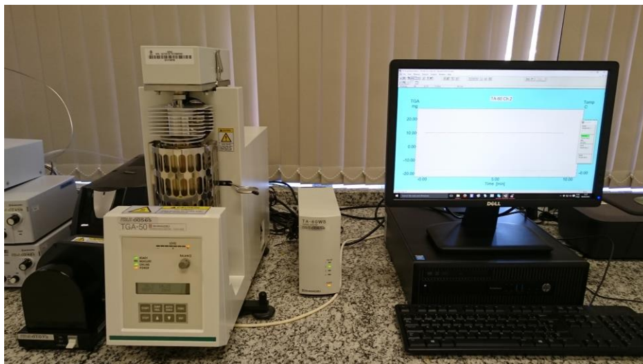
Figura 4.16. Termoanalisador Shimadzu utilizado para a análise termogravimétrica.
