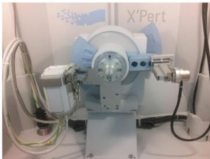
Figura 4.13 Difratômetro de raios X da marca PANalytica, modelo X' PERT. Fonte: Laboratório de Química Analítica da UNIFEI.
