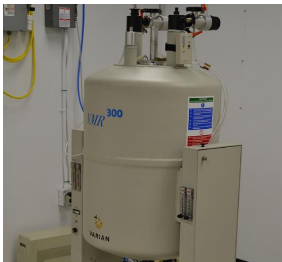
Figura 4.15. Espectrômetro de ressonância magnética nuclear Varian 300 MHz do Instituto de Engenharia Química de Lorena (USP) /Prof. Dra. Jayne Carlos de Souza Barbosa.
