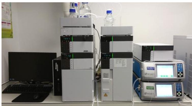
Figura 4.7. Cromatógrafo de permeação em gel (GPC) Shimadzu com um detector de índice de refração RID10A (RI), um detector de dispersão de luz estática de ângulo de Wyatt Heleos 8 e um ensaio de fotodiodo SPD-M20A (UV-vis PDA). Fonte: Shimadzu do Brasil.
