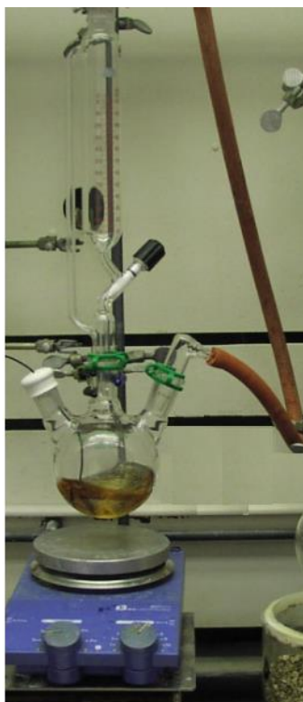
Figura 4.3. Reator utilizado no acoplamento do monômero HEMA com OSE. O equipamento encontra-se no LAT-EFEI.
