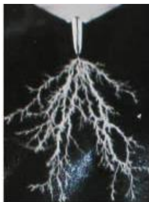
Figura 1.2. Arborescência elétrica (Adico, 2013).
