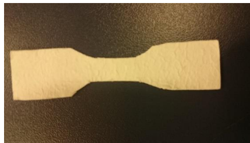
Figura 4.10. Corpo de prova de SiR e SiR/PVH, segundo a norma DIN 53504, obtidos através utilização da prensa de rolo para ensaio de tração. Fonte: A autora.
