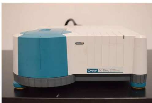
Figura 23: Aparelho de UV-vis Cary 50.
