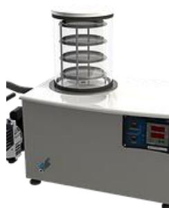
Figura 25: Liofilizador de bancada LJJ04.
