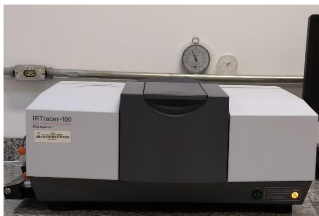
Figura 22: Aparelho de FTIR Tracer 100.
