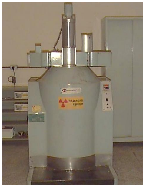
Figura 16. Irradiador Gammacell do Centro de Tecnologia das Radiações do Instituto de Pesquisas Energéticas e Nucleares, CTR-IPEN, São Paulo. O irradiador utiliza o ^{60}\text{Co} como emissor gama.
