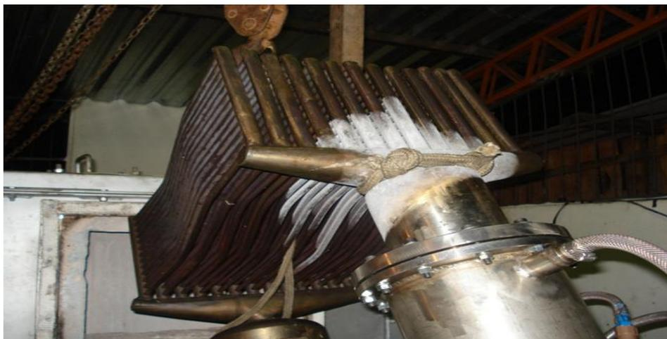
Figura 4-23. Motor Stirling Amazon trabalhando como maquina de frio.
