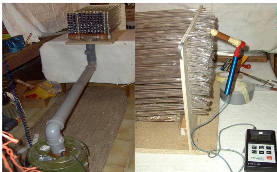
Figura 4-24. Versão do trocador de calor quente em escala normal
