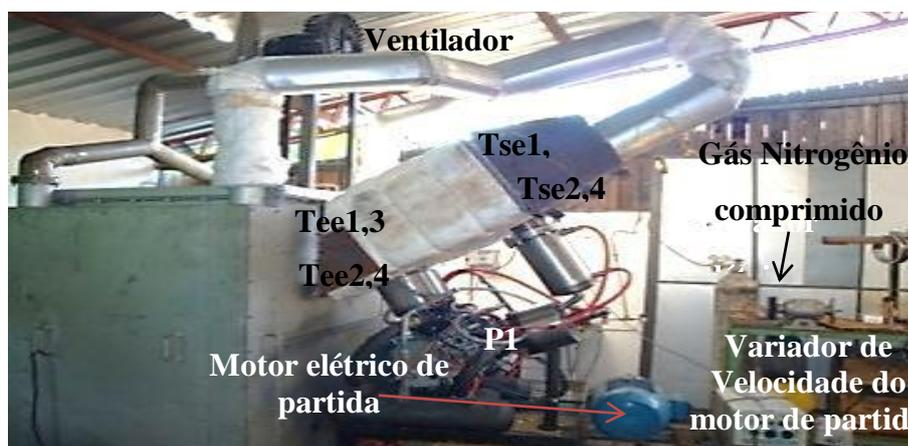
Figura 5-1. Bancada de ensaios utilizando o motor Stirling Amazon.
