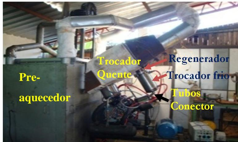
Figura 3-3. Sistema geral do motor Stirling integrado com a fornalha de biomassa.
