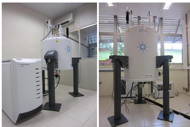
Figura 29 - Aparelhos de ressonância magnética nuclear de carbono treze e hidrogênio (RMN ^{13}\text{C} e ^1\text{H} ) do Instituto de Química da Universidade de São Paulo/São Carlos [240].
