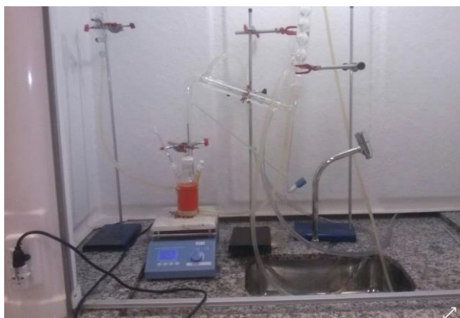
Figura 27 - Reator da síntese do conjugado do dendrímero de poliglicerol com o complexo de boro e curcumina (PGLDBC).
