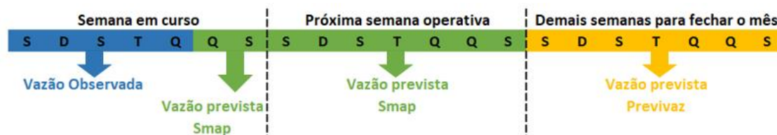
Figura 2 - Esquema ilustrativo do processo de previsões de vazão semanal para programação da operação de uma bacia calibrada para o Smap
