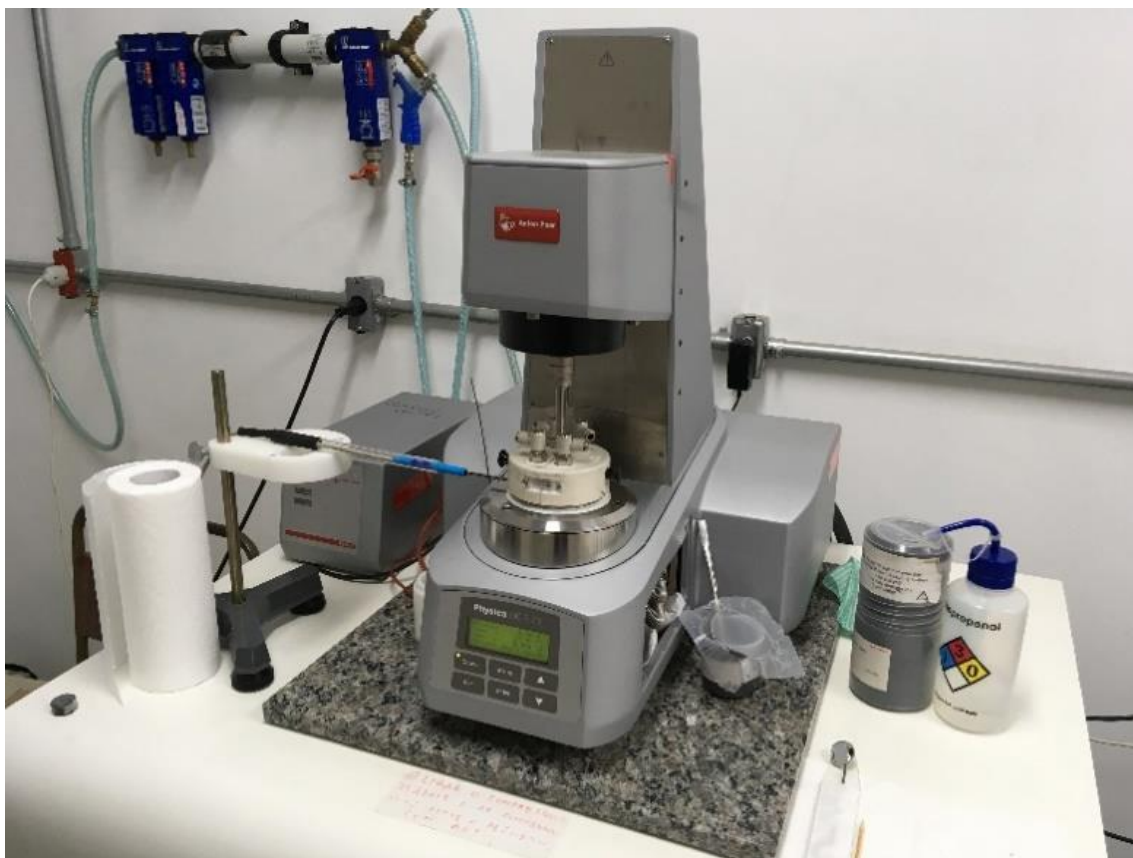
Figura 10 – Reômetro MCR 301 utilizado para avaliação das propriedades reológicas das amostras de suspensões magnetoreológicas.
