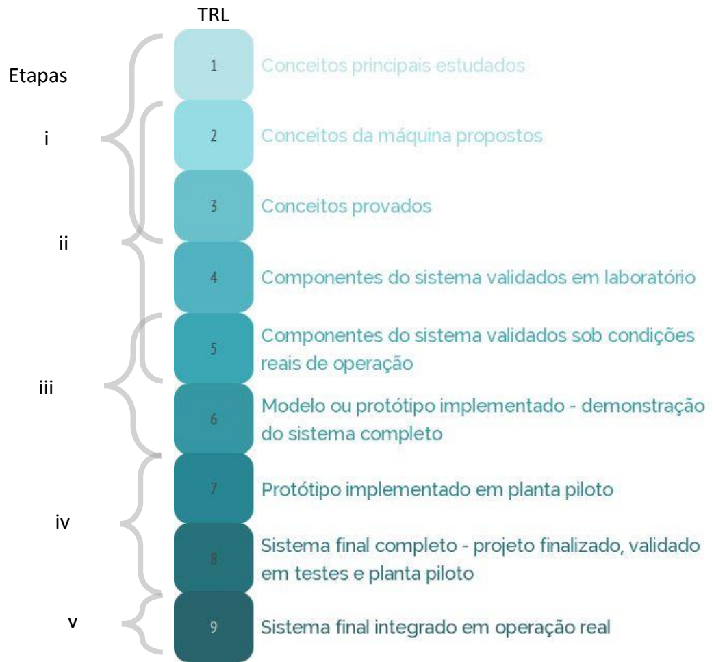
Figura 3.2: Níveis TRL adaptados para turbinas hidrocinéticas, distribuição em cinco etapas do desenvolvimento tecnológico
