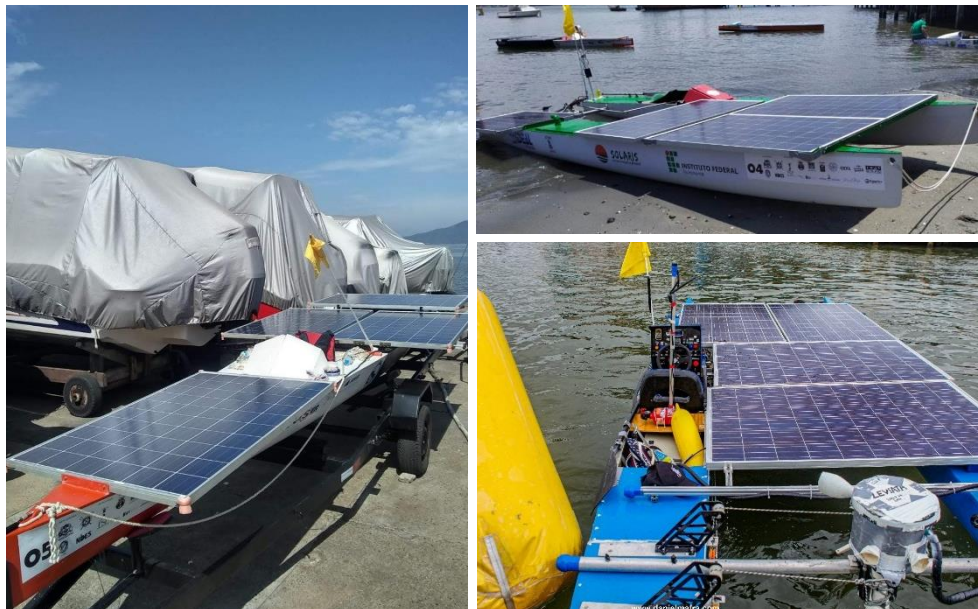
Figura 4: Exemplos de embarcações que utilizam energia solar através de painéis fotovoltaicos. Fonte: Elaborada pelo autor, 2020.
