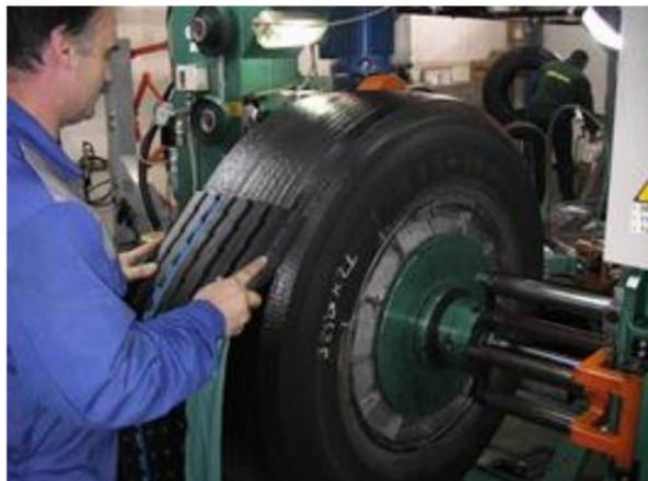
Figura 3.7 – Colação da banda de rodagem em processo de reforma
