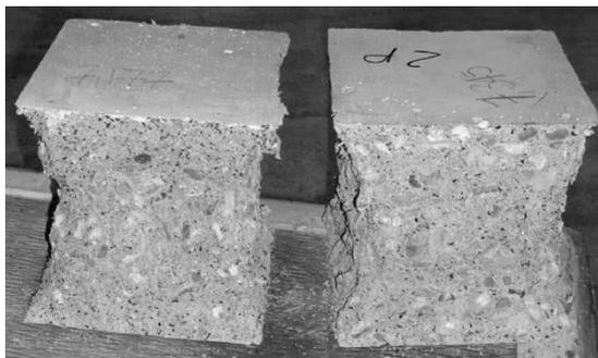
Figura 3.8 – Blocos de concreto com adição de borracha de pneus
