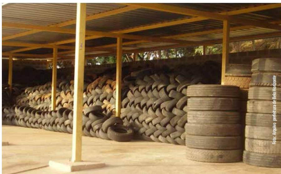
Figura 5.4 – Forma adequada para colocação de pneus inservíveis no ecoponto
