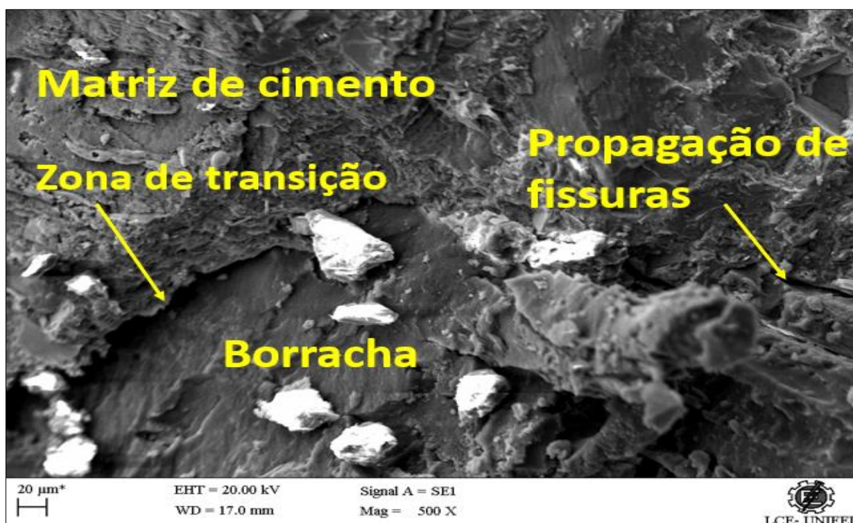
Figura 4.38: Microestrutura do concreto autoadensável com 30% de borracha com granulometria G2 (30 G2) por MEV – módulo elétrons secundários.
