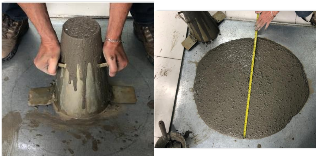
Figura 4.11: Ensaio Slump Flow Test (Fonte: AUTOR, 2020).
