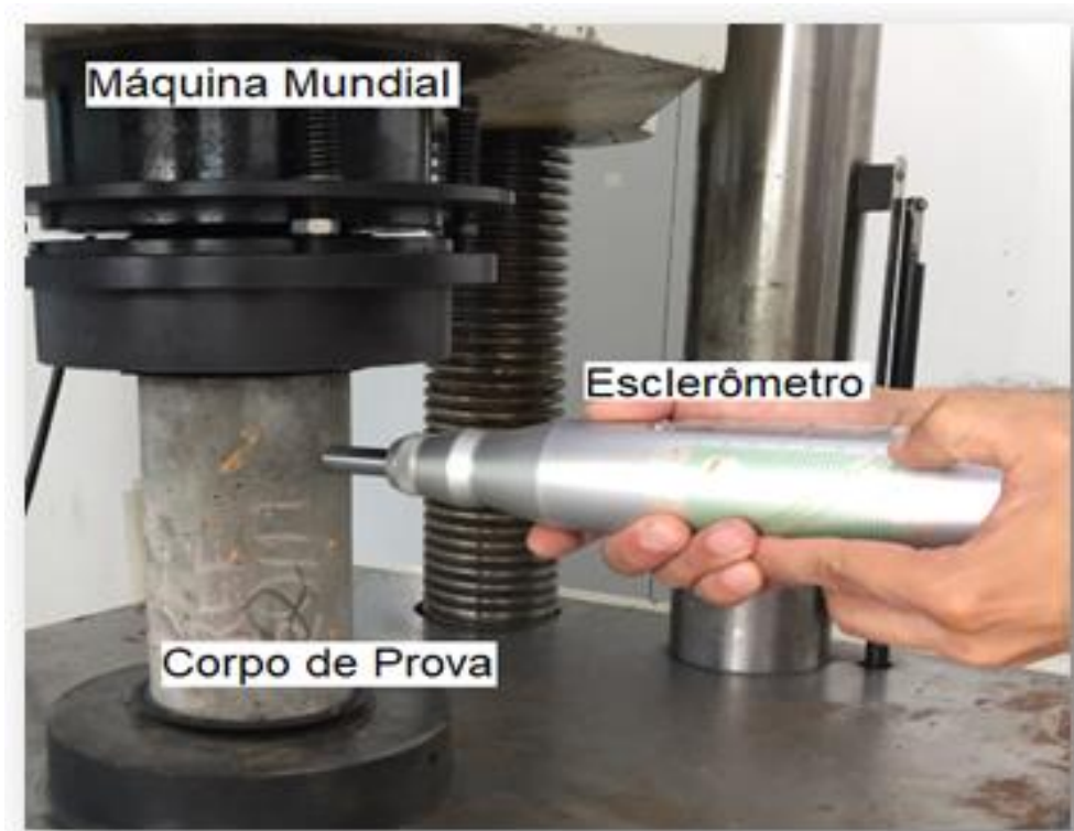
Figura 3.16: Ensaio com Esclerômetro (Fonte: AUTOR, 2020).
