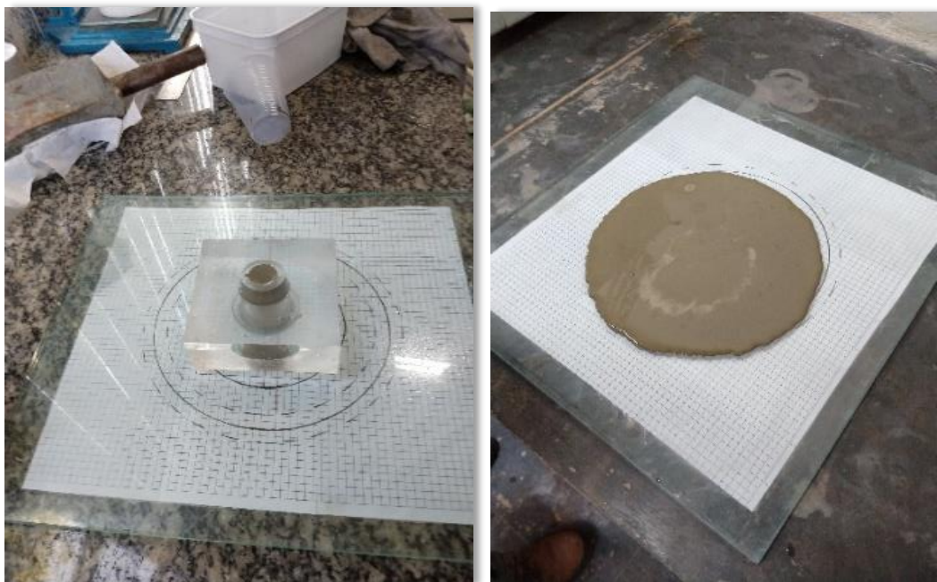
Figura 4.5: Ensaio de pasta. Cone de Kantro (mini 93lump) (Fonte: AUTOR, 2020).
