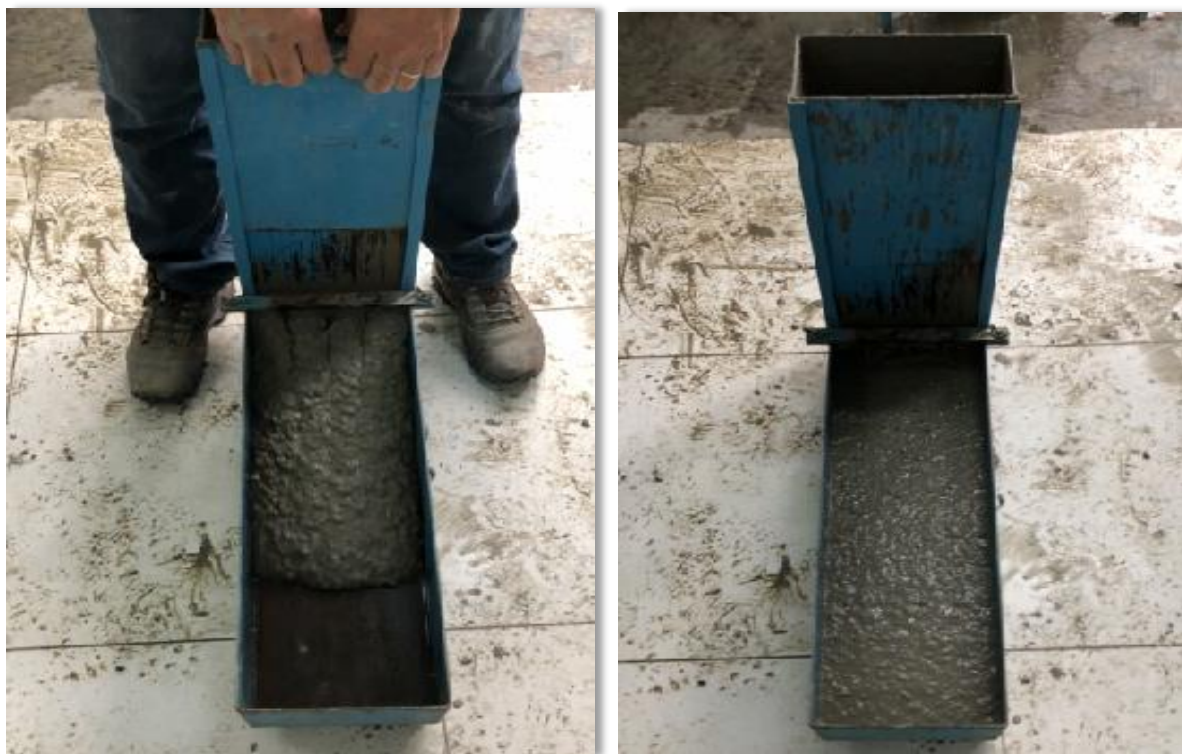
Figura 4.13: Ensaio Caixa L (Fonte: AUTOR, 2020).
