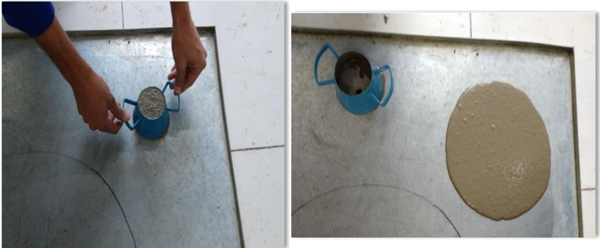
Figura 4.6: Ensaio de argamassa. Cone de Consistência (mini tronco de cone) (Fonte: AUTOR, 2020).
