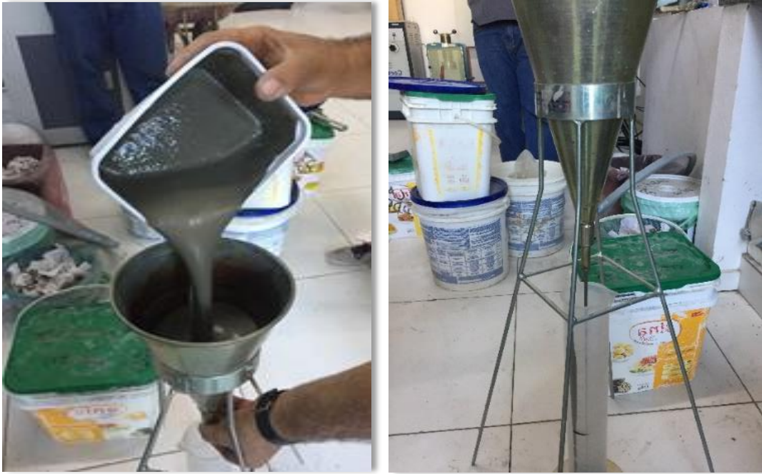
Figura 4.4: Ensaio de pasta. Cone de Marsh (Fonte: AUTOR, 2020).
