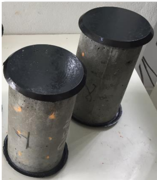
Figura 3.11: Corpos de prova com capeamento à base de enxofre (Fonte: AUTOR, 2020).
