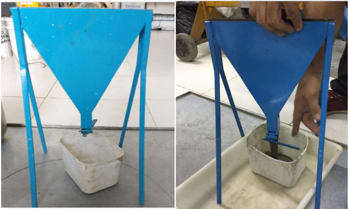
Figura 4.7: Ensaio de argamassa. Mini funil V (Fonte: AUTOR, 2020).
