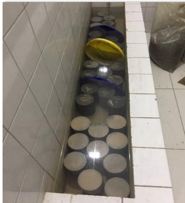
Figura 3.10: Câmara Úmida (Fonte: AUTOR, 2020).
