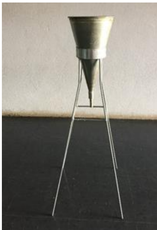
Figura 3.2: Cone de Marsh para determinação do ponto de saturação do superplastificante (Fonte: AUTOR, 2020).
