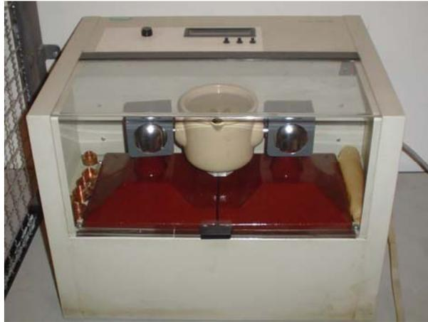
Figura 3.2 – Analisador de rigidez dielétrica
