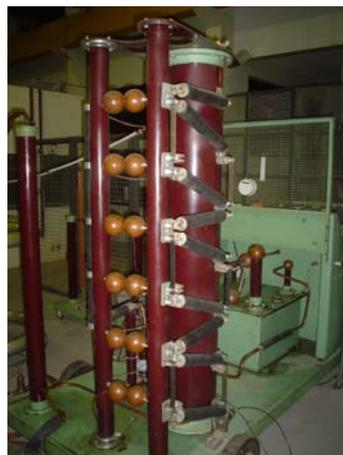
Figura 3.4 – Capacitores e resistências
