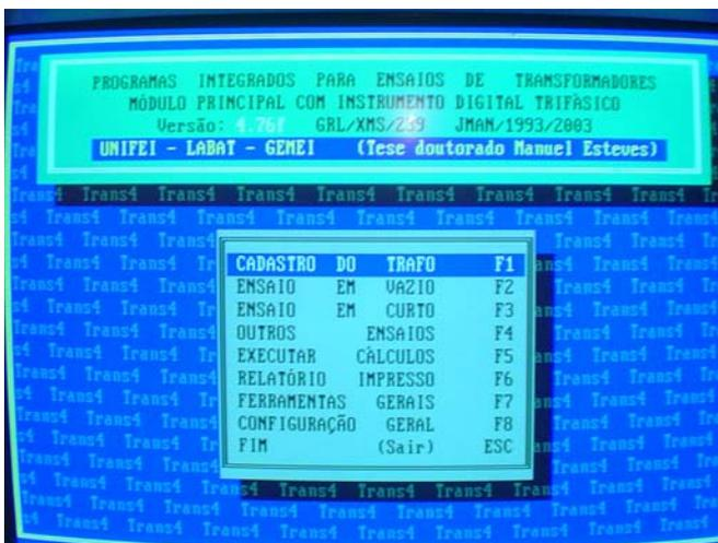
Figura 3.26 – Software de ensaio em vazio e em curto-circuito
