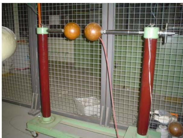
Figura 3.5 – Centelhador externo
