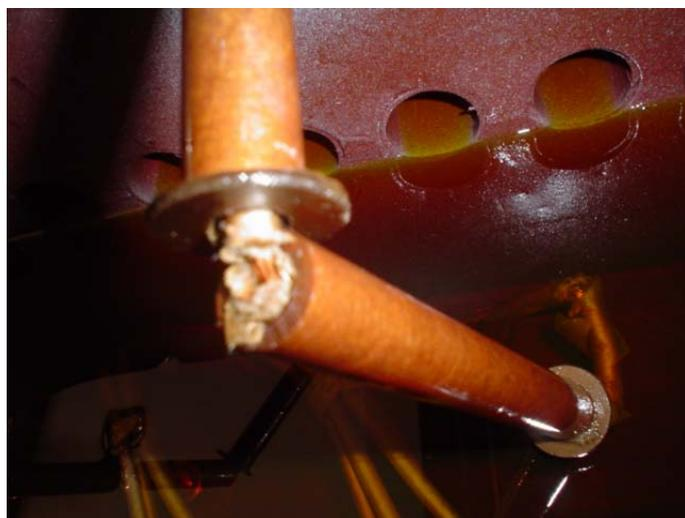
Figura 4.6 – Quebra no fio de alta tensão
