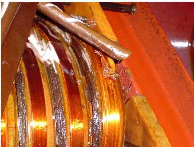
Figura 4.11 – Conexão entre camadas do enrolamento mal feitas
