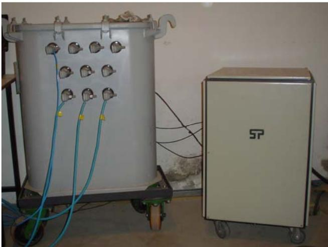
Figura 3.22 – Transformador de alimentação e variac
