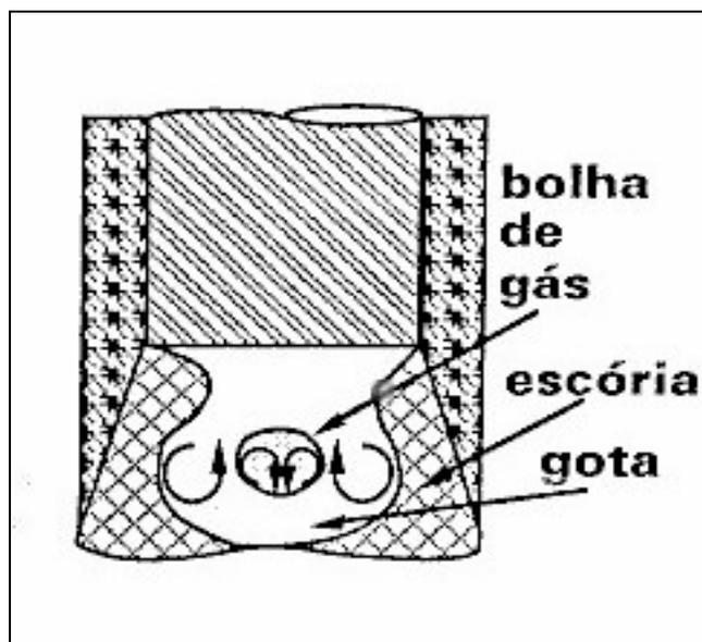
Figura 2.4 - Esquema de circulação de uma bolha de gás no interior da gota em um eletrodo rúflico (BRANDI,1988)
