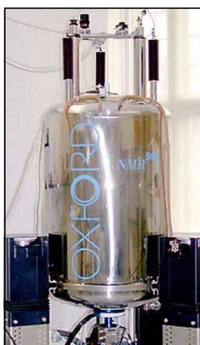
Figura 22 – Espectrômetro utilizado para caracterização do polímero PCL:I 2 .
