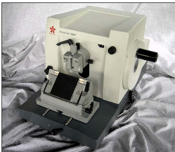
Figura 29 – Micrótomo rotatório Sakura ® modelo Accu-Cut SRM, Tissue-Tek utilizado para segmentar os fragmentos ósseos.
