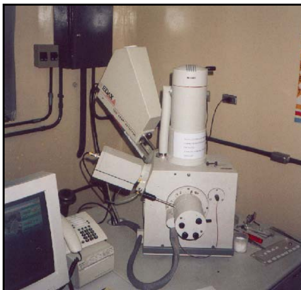
Figura 21 – Microscópio eletrônico de varredura Philips XL30 (IPEN/USP) utilizado para a análise do compósito PCL:I 2 /HA.
