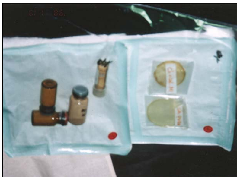
Figura 28 – Compósito de PCL:I 2 /HA (A) e as membranas de quitosanas esterilizadas por raios gama ( 60 Co) (B). Dose utilizada = 25kGy.
