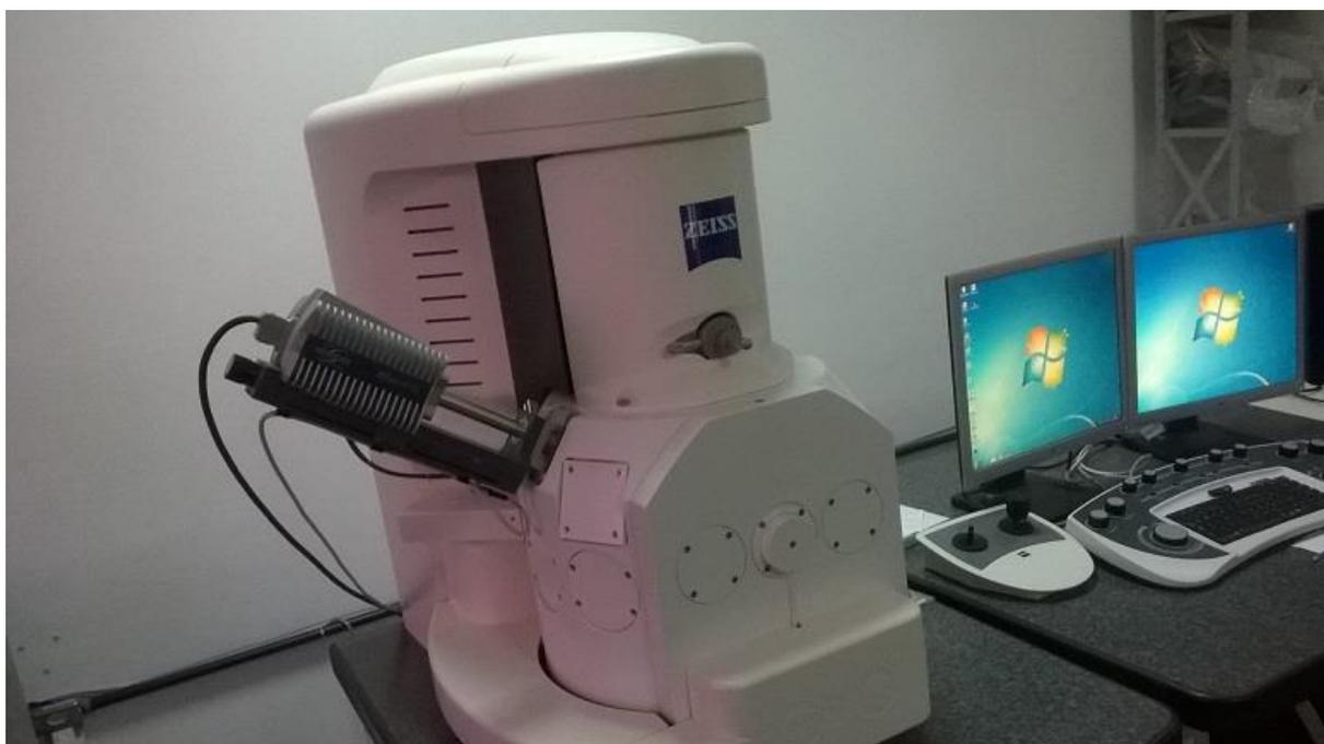
Figura B.18: Fotografia de microscópio eletrônico de varredura modelo MA15EVO XFLASH 6I10 da marca ZEISS.
