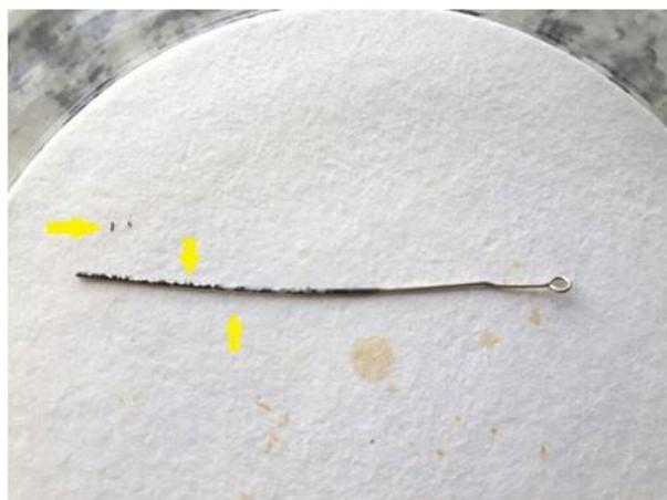
Figura B.12: Ilustração do eletrodo de trabalho com desprendimento da magnetita após ataques intensos de bolhas de hidrogênio.
