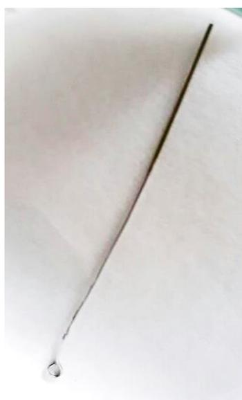
Figura B.5: Fotografia do eletrodo de trabalho revestido de PANI após secagem na estufa a temperatura constante de 60 °C sob pressão de 1 atm por 3 min.
