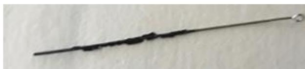
Figura B.9: Ilustração do eletrodo de platina incrustada de magnetita após o processo de eletrodeposição.
