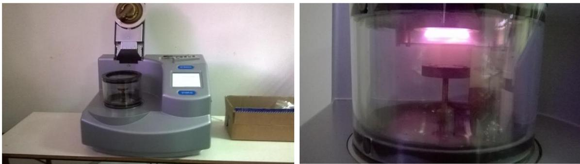
Figura B.20: Metalizador para deposição de ouro nas amostras modelo Q150R E5 da marca Quorum Technologies com vácuo de  $2 \times 10^{-3}$  mbar. Tempo de deposição: 9 minutos. Corrente de pulverização: 0 ~ 80 mA.
