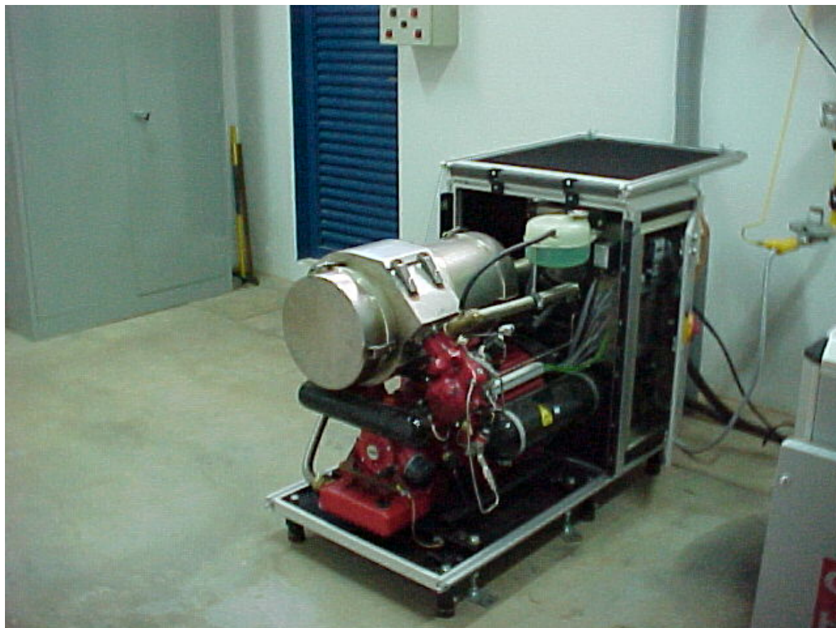
Figura 4-2 Instalação do motor Stirling Solo 161 no Laboratório de Sistemas Avançados em Geração Distribuída da UNIFEI. (vista lateral).
