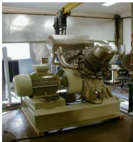
Figura 3-18 Motor Stirling de 35 kW construído a partir do bloco de um compressor de ar.
