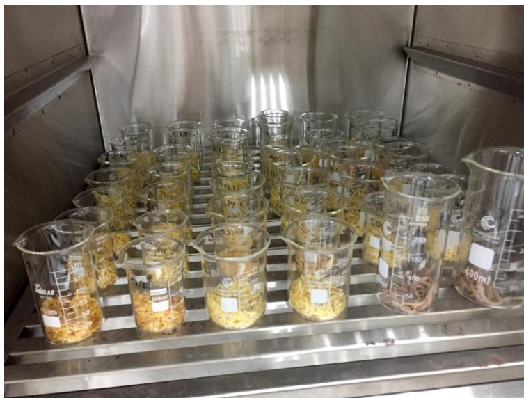
Figura 4.6 - Determinação do teor de umidade das amostras
