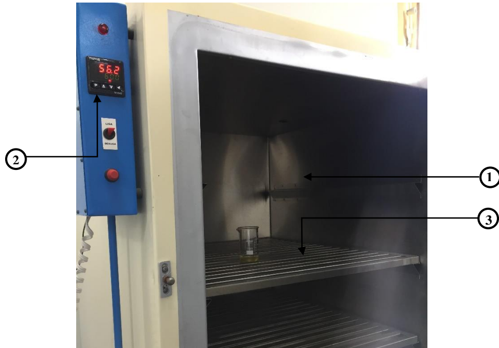
Figura 4.5 - Forno de convecção utilizado para determinação do teor de umidade das amostras
