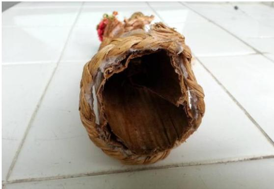
Figura 60 - Deformação na base e descolamento da corda de fibra de bananeira
