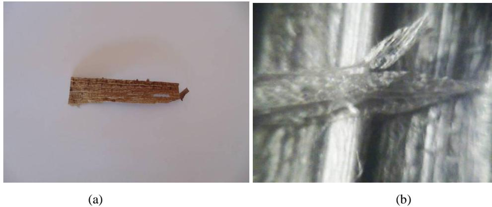
Figura 43 - (a) Amostra utilizada na MO com a renda fixa na fibra seca e (b) renda fixa na fibra com magnificação em 20X
