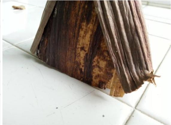
Figura 64 - Deformação na base da amostra 2
