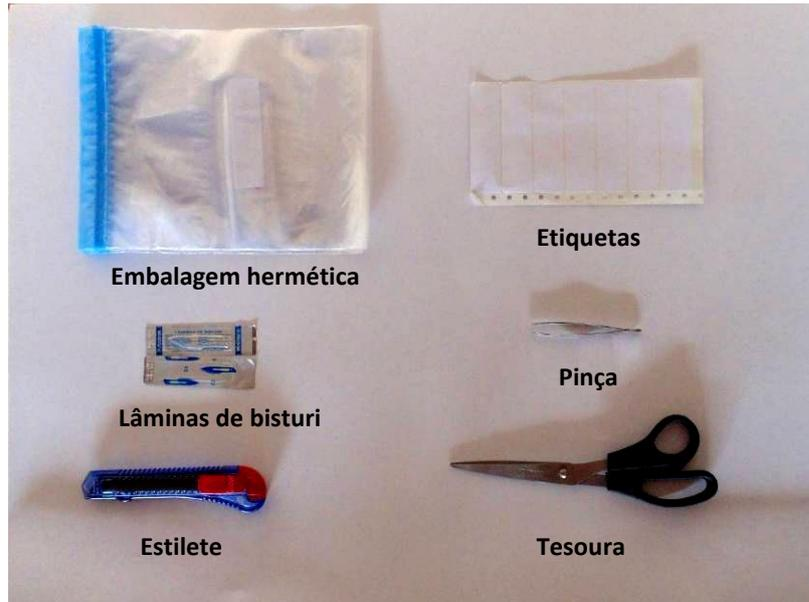
Figura 8 - Instrumentos utilizados na coleta das amostras de fibras
