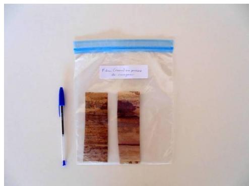
Figura 38 - Amostra das fibras retiradas da casca em processo de secagem da bananeira
