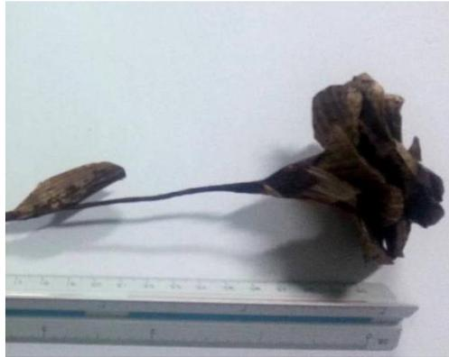
Figura 66 - Flor de fibra de bananeira submetida ao teste de degradação de 30 dias
