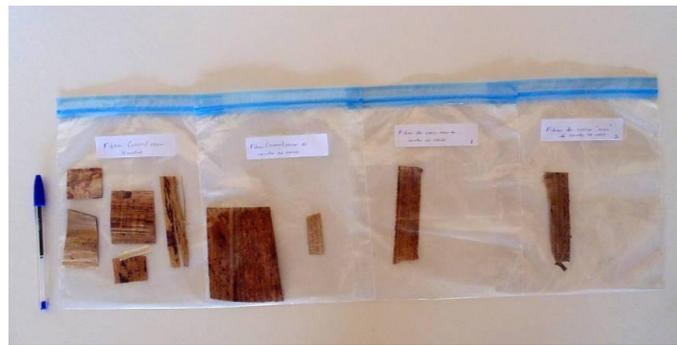
Figura 37 - Amostra das fibras extraídas da casca seca da bananeira
