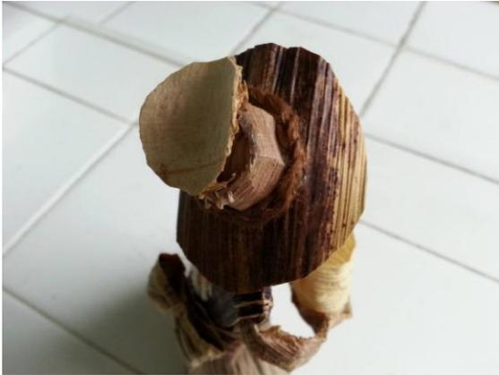
Figura 63 - Descolamento da parte superior do "chapéu" da amostra 2
