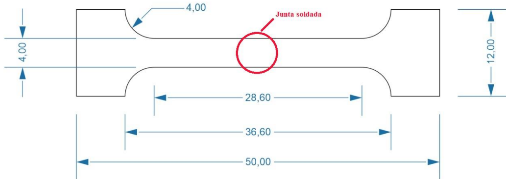
Figura 23- CP usinado para o ensaio de tração
