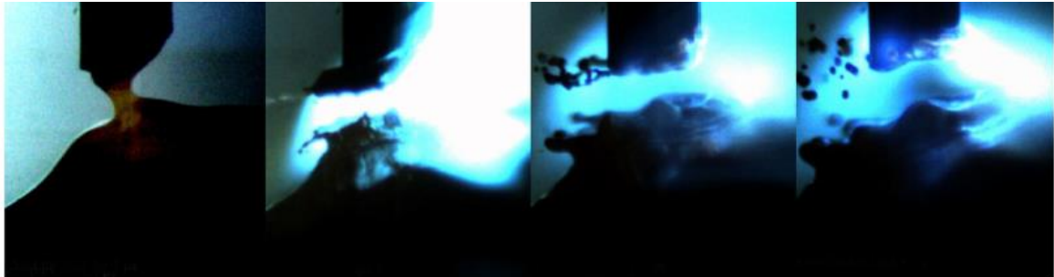
Figura 5- Geração de respingos em Transferência por curto-circuito convencional (WILHELM et al. , 2010)
