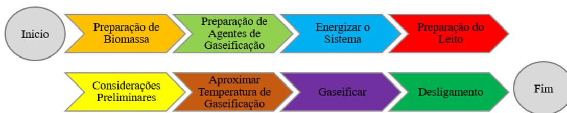
**Figura 3.8** Diagrama de fluxo geral para gaseificação de biomassa.
