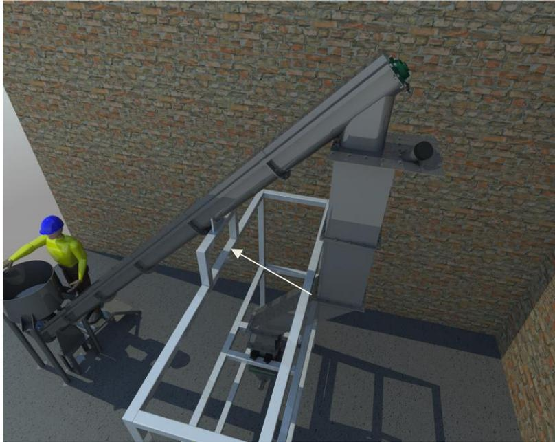
**Figura 7.17** Perspectiva do suporte do silo na estrutura do gaseificador.
