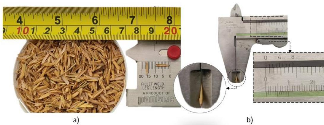
**Figura 3.1** Dimensões gerais de Casca de arroz. a) Comprimento e Largura; b) Espessura.
