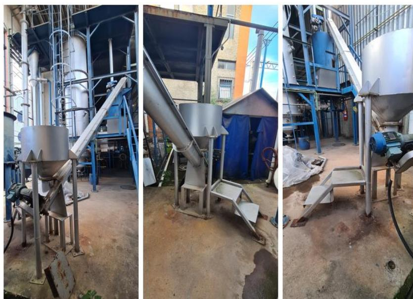
**Figura 7.14** Sistema de alimentação de biomassa alternativo.
