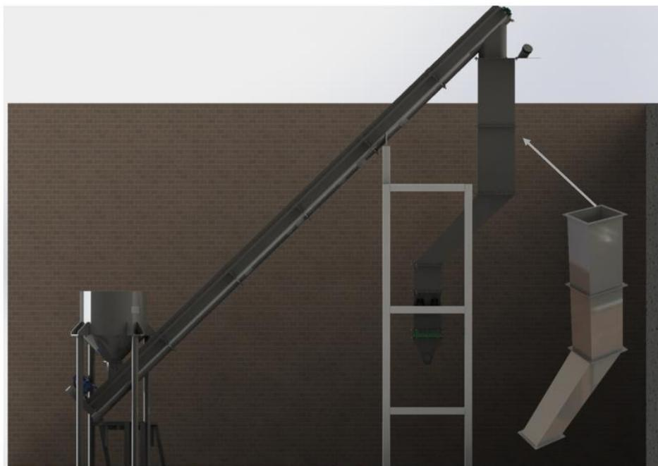
**Figura 7.16** Ajuste do sistema de fornecimento alternativo no GLFB atual. (Lateral)
