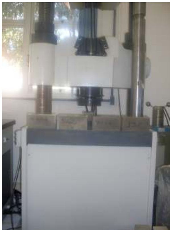
Figura 18: Máquina utilizada para ensaio de resistência à compressão
