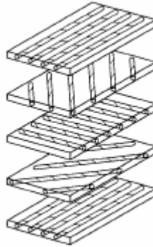
Figura 3.7 – Exemplo de superposição de camadas para composição de um laminado. (Fonte: Jones (1999)).
