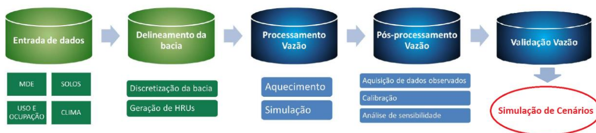
Figura 12 – Etapas sequenciais da modelagem hidrológica com o SWAT.
