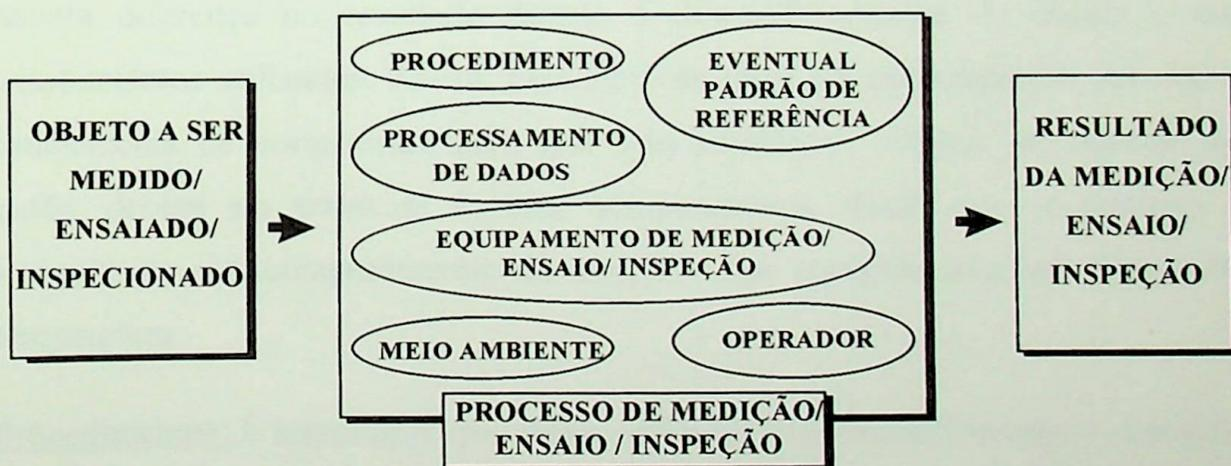
Figura 3.2 - Elementos dos processos de inspeção, medição e ensaios
