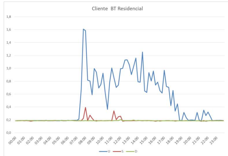
Figura 20 - Exemplo das curvas de carga representativas (dia útil - U, sábado -S e domingo - D), por unidade da média, de um cliente BT residencial extraída da campanha de medidas da Santa Maria.
