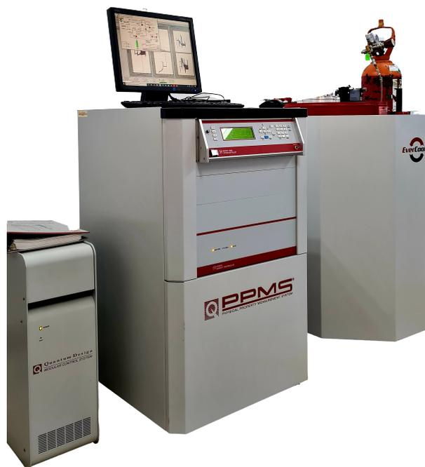
Figura 3.3.2 – **Equipamento PPMS.** *Sistema de medição de propriedades físicas utilizado para as medidas elétricas e de fotocondução.*
