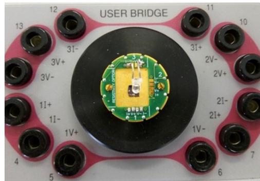
Figura 3.3.1 – **Porta-amostras** (no centro) sobre a plataforma de testes (user bridge), com o LED posicionado acima da amostra.
