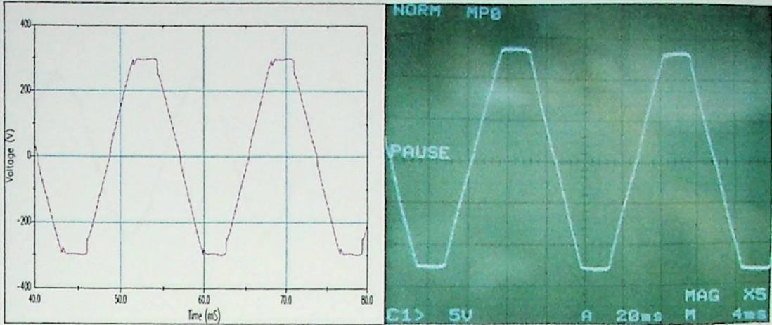
Figura 4.20 - Comparação entre a tensão fase-fase obtida na Simulação, e a medição realizada no laboratório, para o caso em  $S_{cc} = 60 \times S_{conv}$
