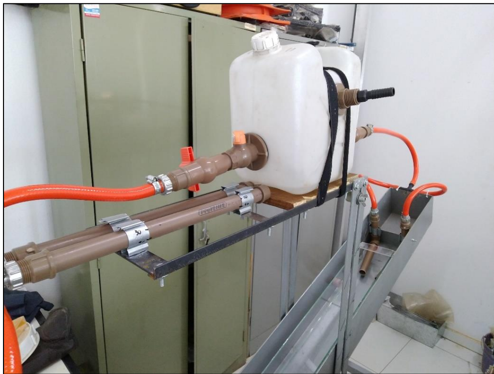
Figura 17 - Rampa de Inderbitzen após modificações (vista 1) Fonte: Autoria própria
