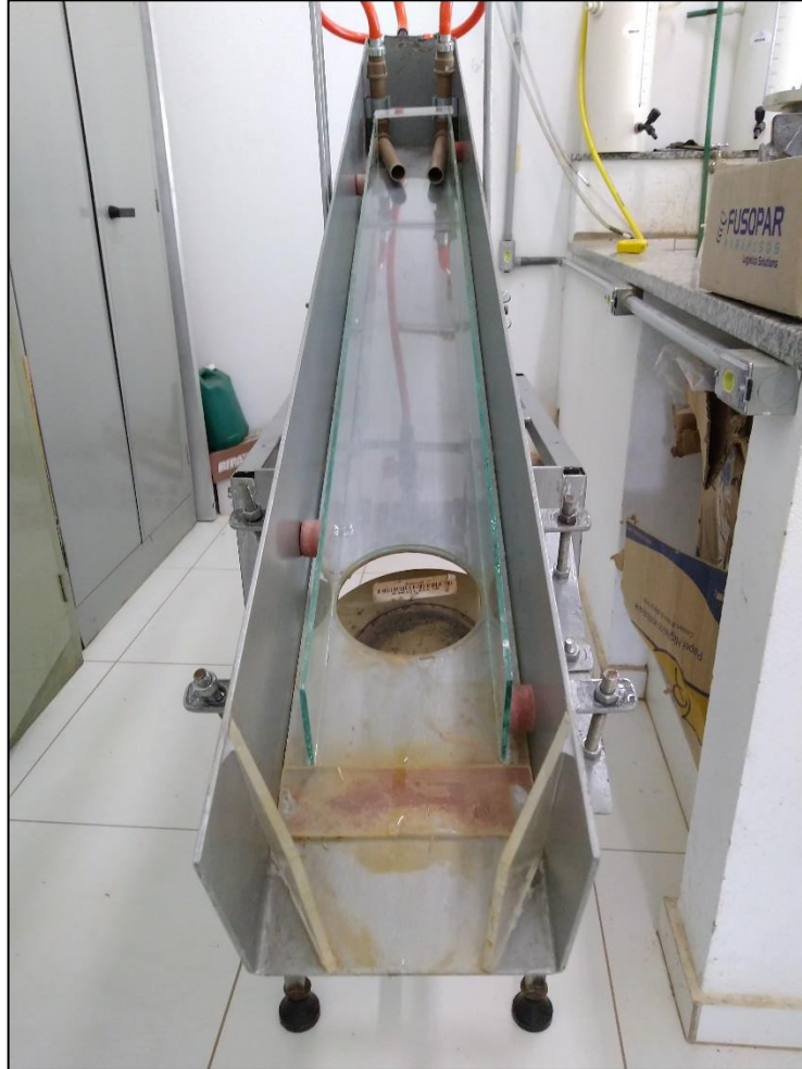
Figura 18 – Rampa de Inderbitzen após modificações (vista 2) Fonte: Autoria própria
