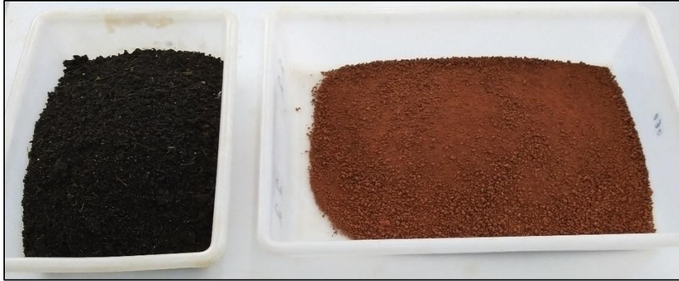
Figura 14 – Lodo e solo puro, previamente à mistura e ajuste de umidade Fonte: Autoria própria
