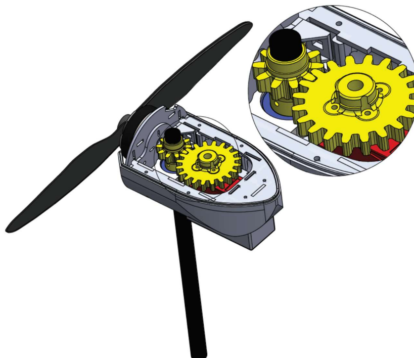
Figura 3 - Detalhe do sistema propulsivo aéreo azimutal. Fonte: Regina, 2020.
