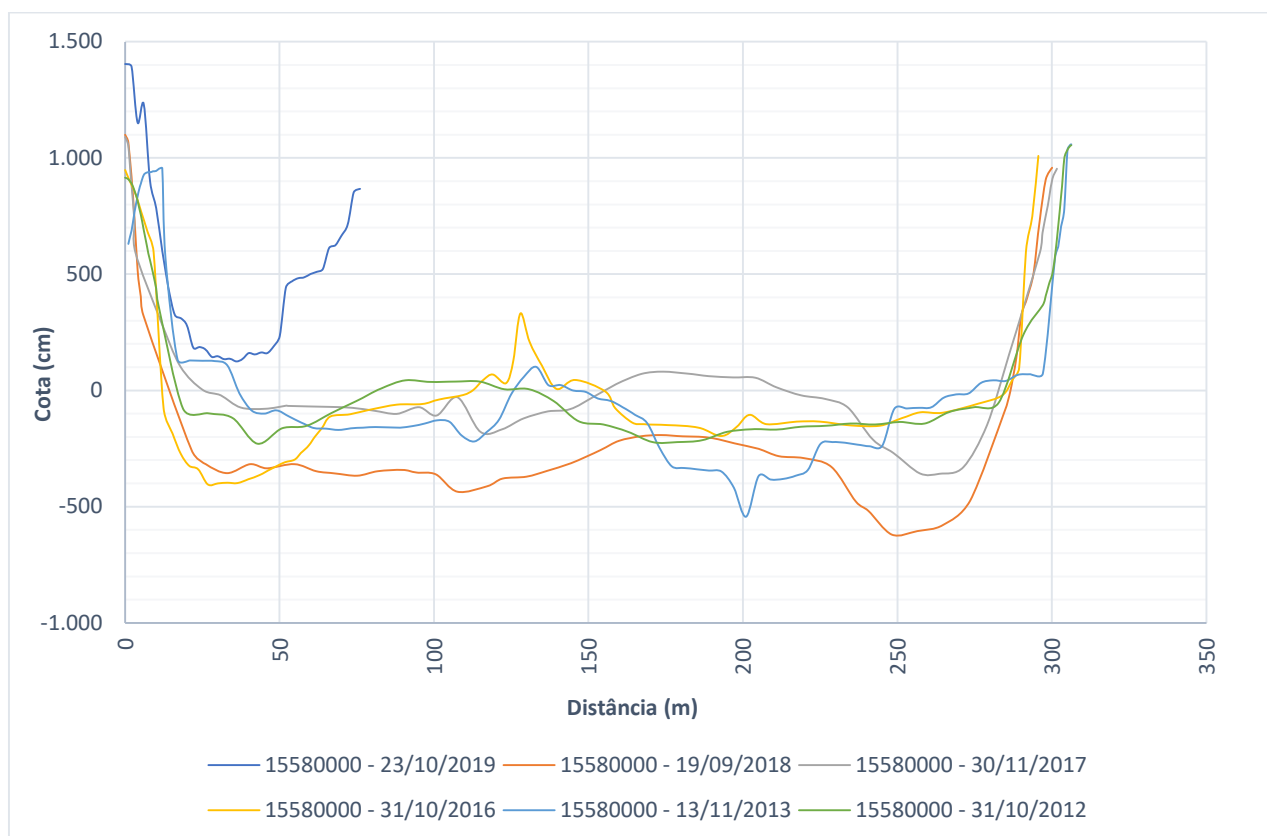
Figura 14 - Histórico das seções transversais da estação fluviométrica Tabajara (15580000). Fonte: Hidroweb, 2021.
