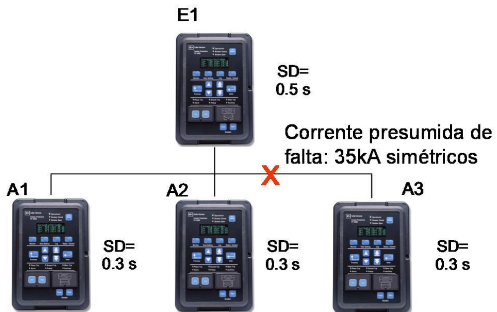
Figura 6.17- Exemplo de aplicação de Seletividade Lógica (ZSI)
