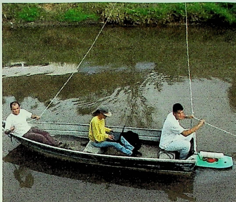
Figura 5.3 - Foto de um arranjo para medição com ADCP em pequenos cursos d'água, utilizado na estação fluviométrica FECL.
