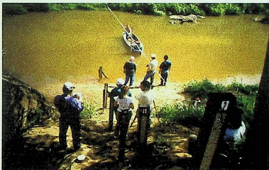
Figura 3.3 - Medição de vazão a vau com barco na estação fluviométrica Luiz Dias, localizada na PCH Luiz Dias, Rio Lourenço Velho, Itajubá - MG.
