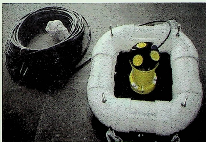
Figura 5.7 - Foto de um ADP fixado em uma pequena balsa feita com tubos de PVC.
