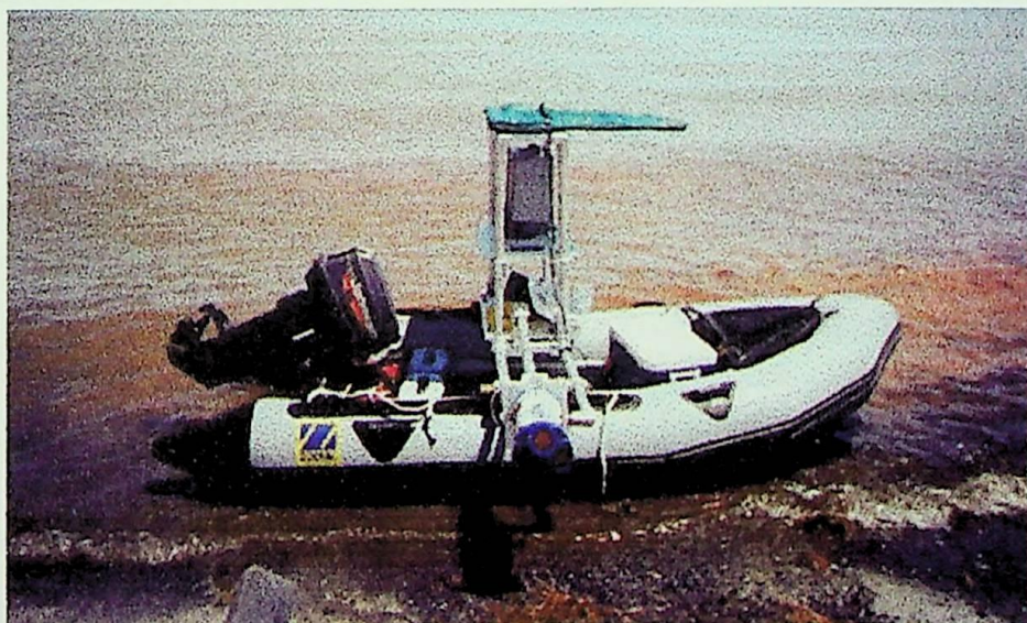
Figura 5.5 - Foto de arranjo com suporte fixo em barco inflável, utilizado pela USGS.
