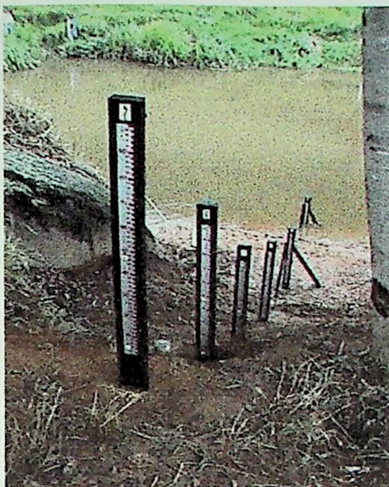
Figura 3.2 - Seção de réguas da estação fluviométrica PCH Luiz Dias.
